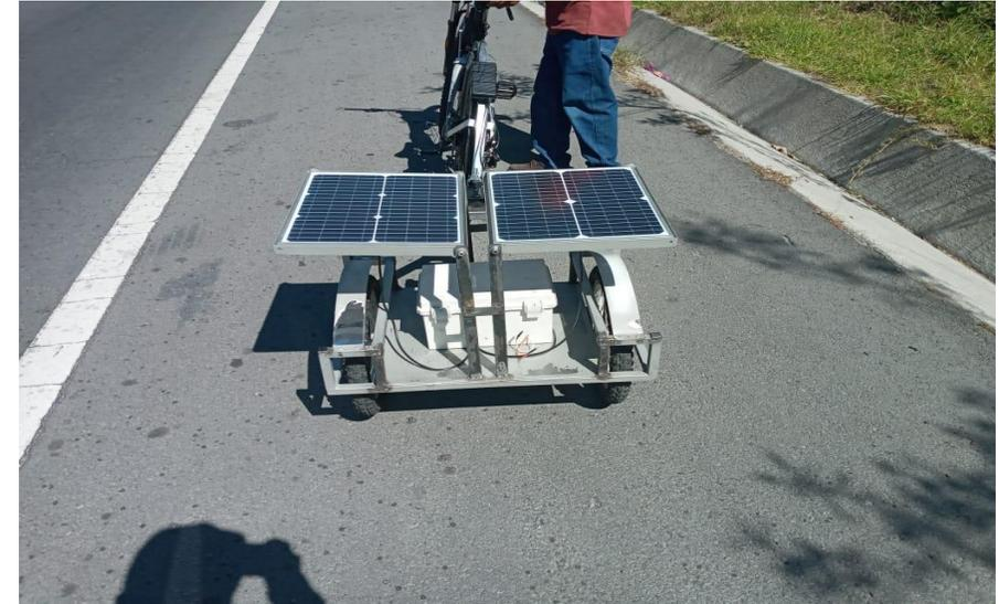
El sistema el alternativo utilizado es Topsolar Kit de panel solar monocristalino 20W 12V con controlador de carga solar 10A + cable de extensión con clips de batería Terminal de junta tórica para RV Marine Boat Off Grid System
