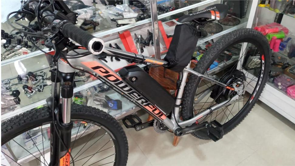
La bicicleta eléctrica consta de un motor eléctrico de 500w, velocidad máxima de 70km/h, acelerador, pantalla digital, selector de asistencia, sensor de pedaleo, batería de 48 V.
