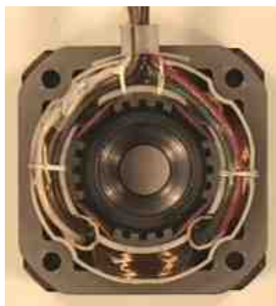
Figura 2.51. Estator de 4 bobinas Motor Paso a Paso
