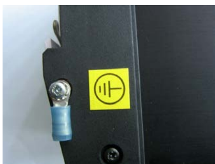
Figura 2.20. Conexión de tierra
