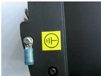
Figura 2.3. Conexión de tierra
