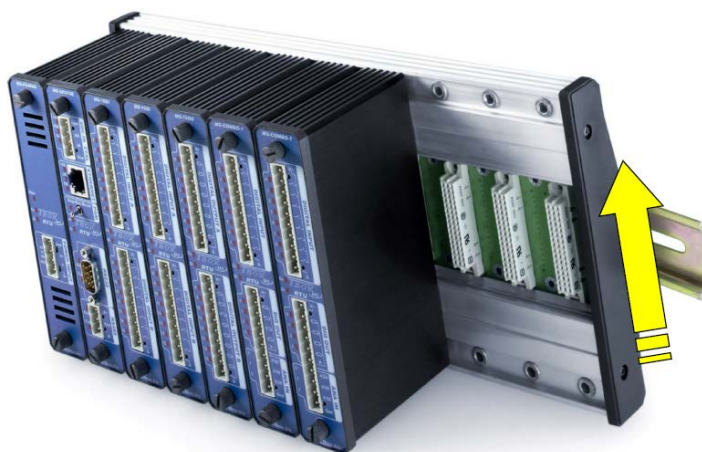
Figura 2.22. Instalación del Rack en un riel DIN (1)
