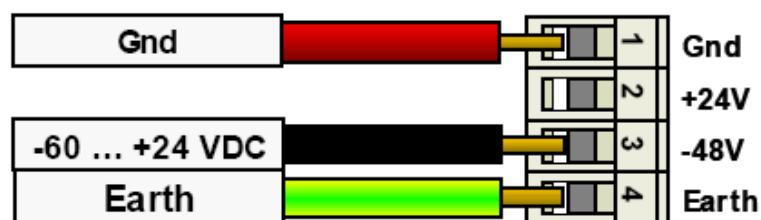
Figura 2.28. Conexión fuente de alimentación -48 VDC
