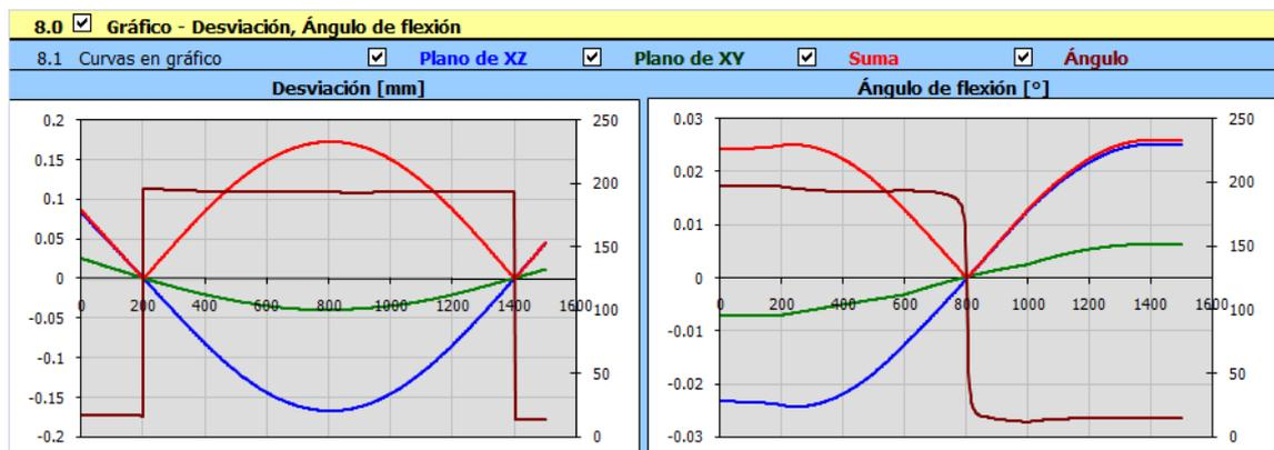
**Figura 4.51 Gráfico – Desviación, ángulo de deflexión del eje (MITCalc)**
