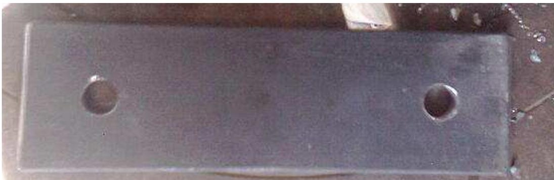
**Figura 5.28 Placa de anclaje construida**
