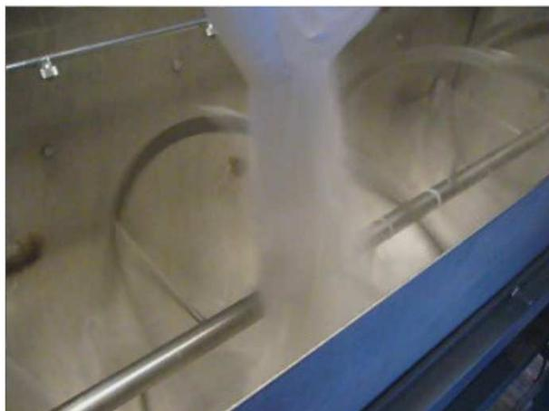
**Figura 6.6 Prueba de fabricación ingreso de carbonato a la tolva**
