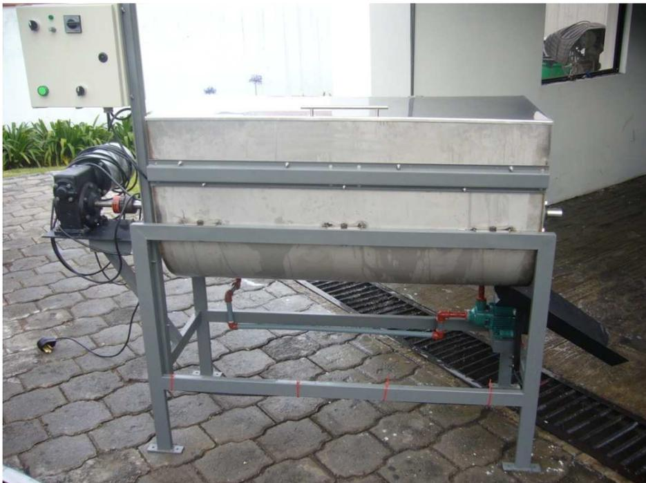
**Figura 5.46 Procesadora de detergente en polvo construida**
