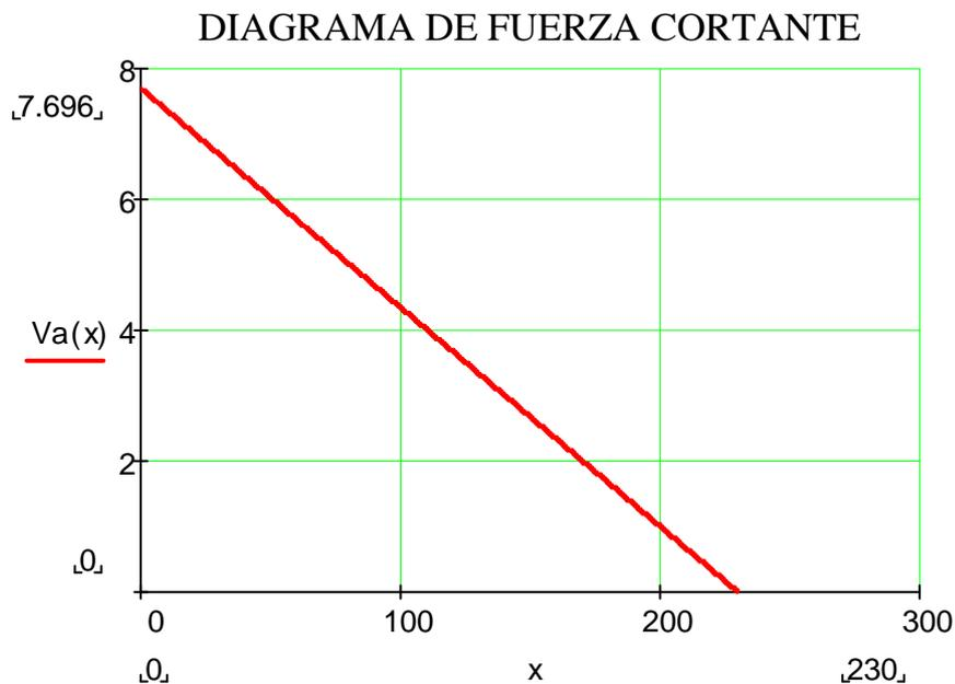
**Figura 4.30 Diagrama de fuerza cortante en barra circular eje Z**
