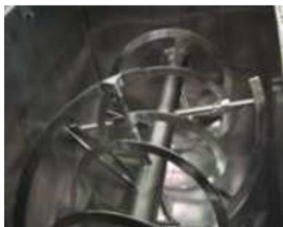
**Figura 2.10 Aspas de doble cinta helicoidal**
