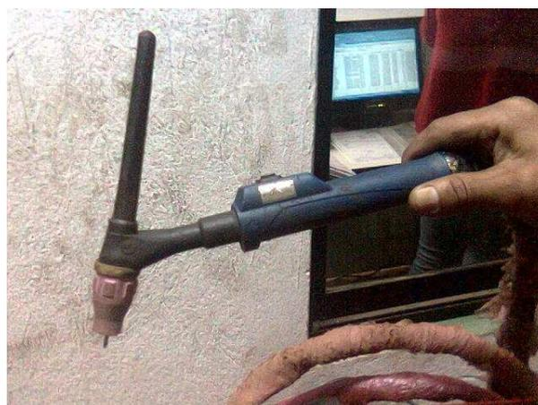
**Figura 5.3 Antorcha de soldadura TIG**
