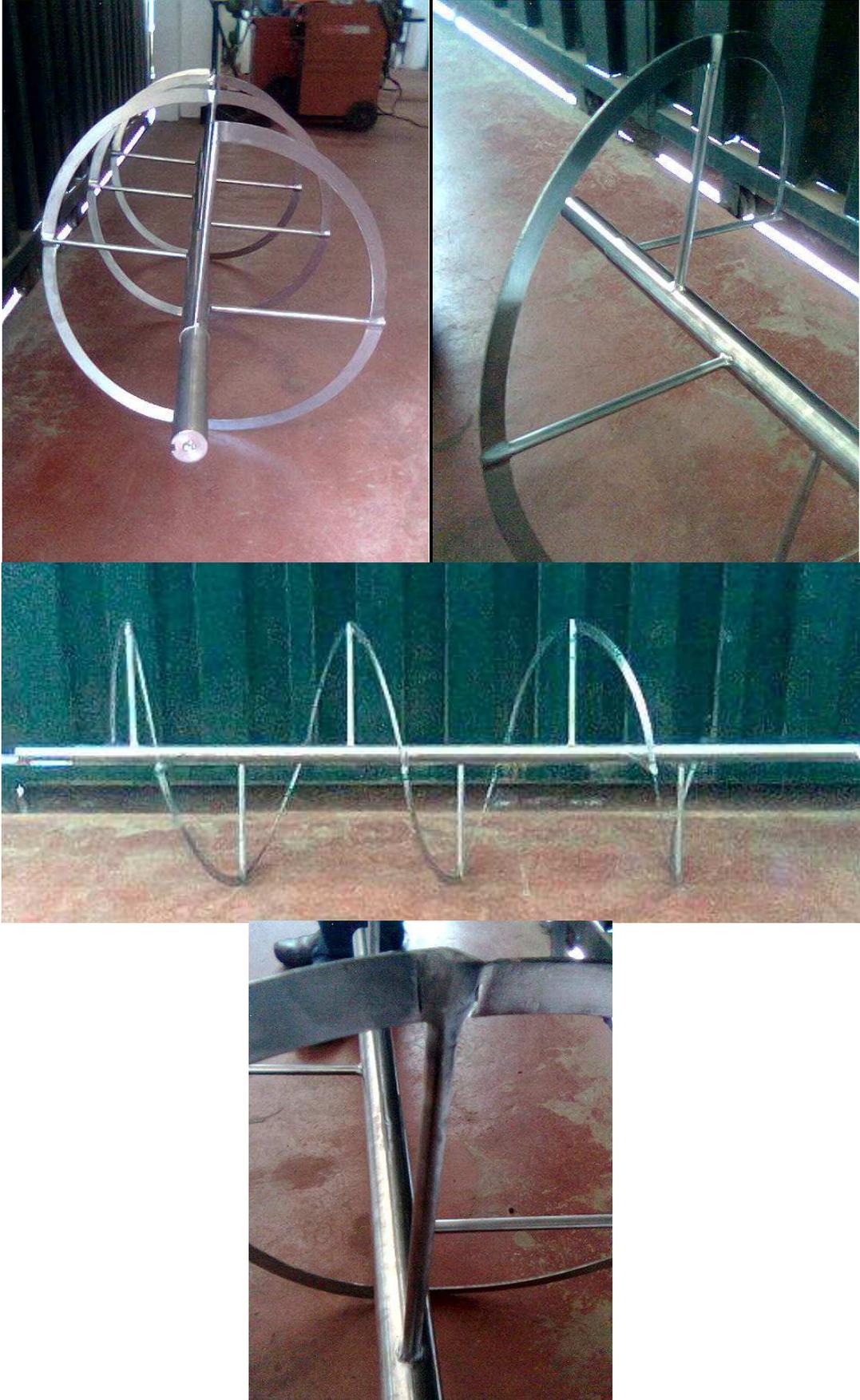
**Figura 5.38 Aspa ensamblada**
