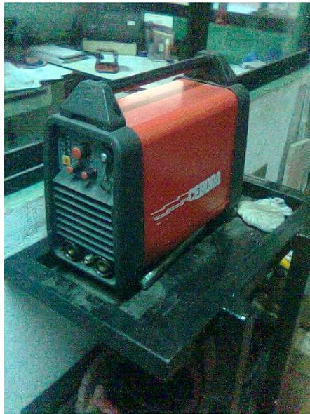
**Figura 5.2 Máquina de soldadura TIG**
