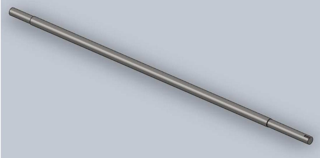
**Figura 5.11 Eje principal del aspa  $\varnothing = 35\text{mm}$ ;  $L = 1500\text{ mm}$**
