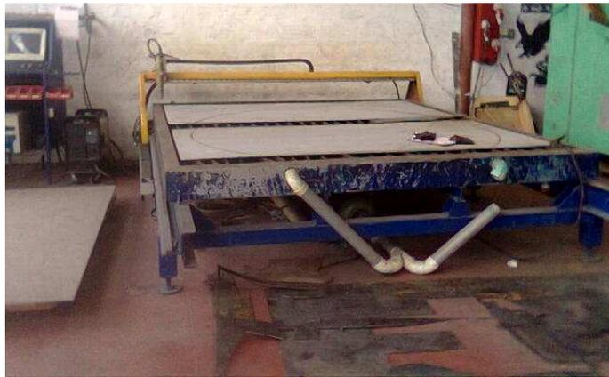
**Figura 5.8 Pantógrafo CNC**
