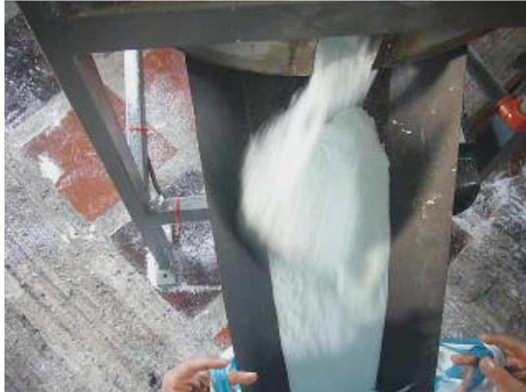
**Figura 6.4 Prueba de salida de producto a través de canaleta**
