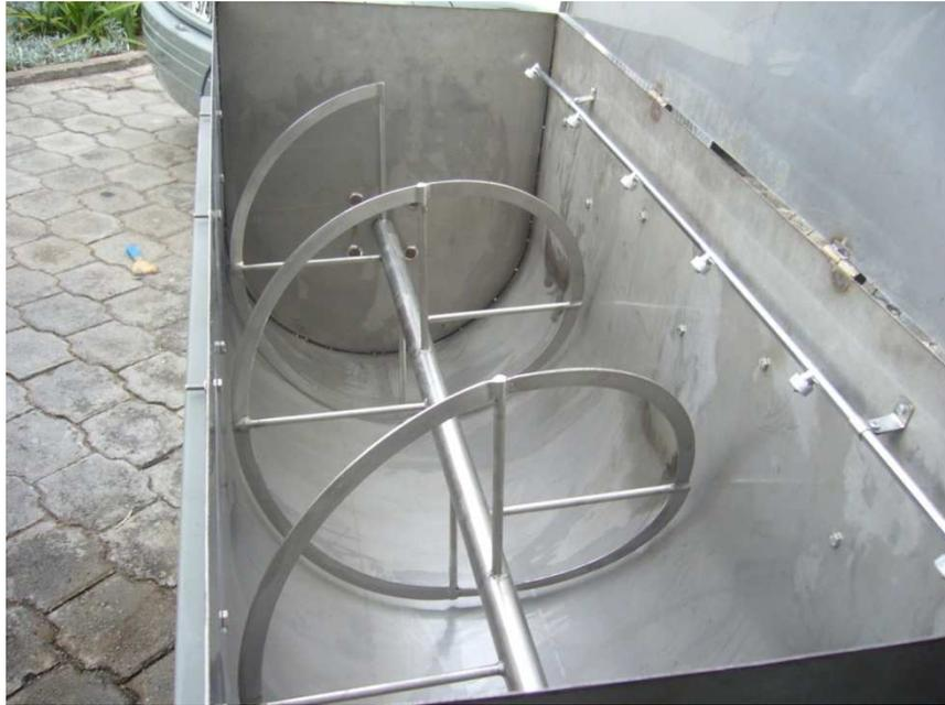
**Figura 5.47 Interior procesadora de detergente en polvo construida**
