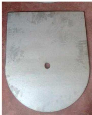
**Figura 5.20 Tapa lateral de tolva construida**
