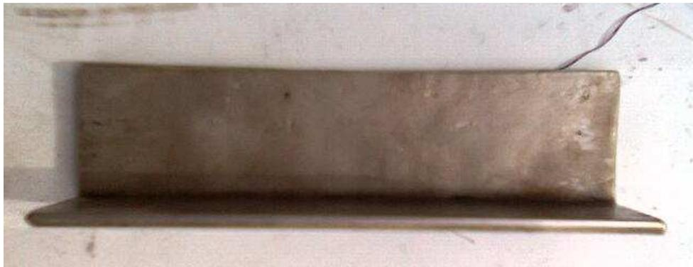
**Figura 5.24 Orejas para sujeción de tolva construidas**
