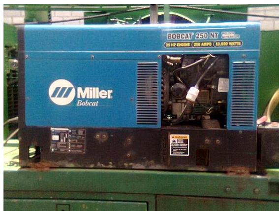
**Figura 5.1 Máquina de soldadura SMAW**
