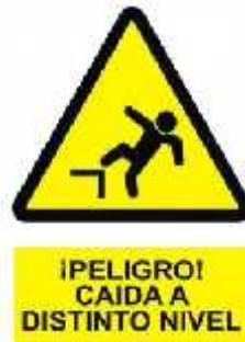
Figura 3.5.- Peligro Caídas a distinto nivel
