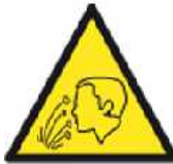
Figura 3.11.- Peligro Proyección de fragmentos o partículas Fuente: http://www.seguridadyaridos.org/senales/25_8_23.jpg Elaborado por: Mario Cruz
