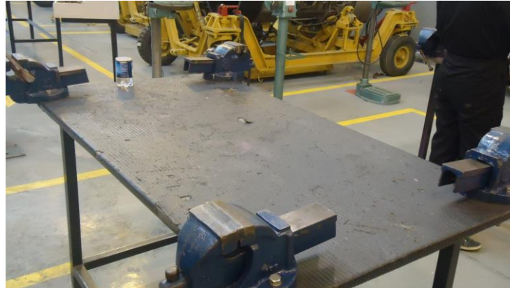
Fig. 23.- Entenallas Fuente: ITSA Bloque N°42
