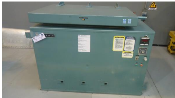
Fig. 9.- Horno para tratamientos Térmicos Fuente: ITSA Bloque N°42
