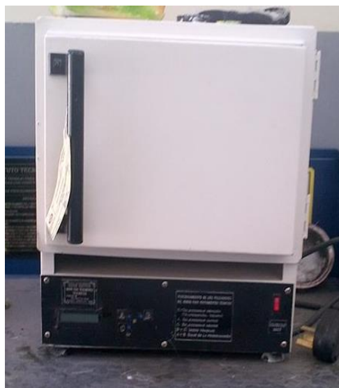
Fig. 46.- Horno para Tratamientos Térmicos Fuente: ITSA Bloque N°42
