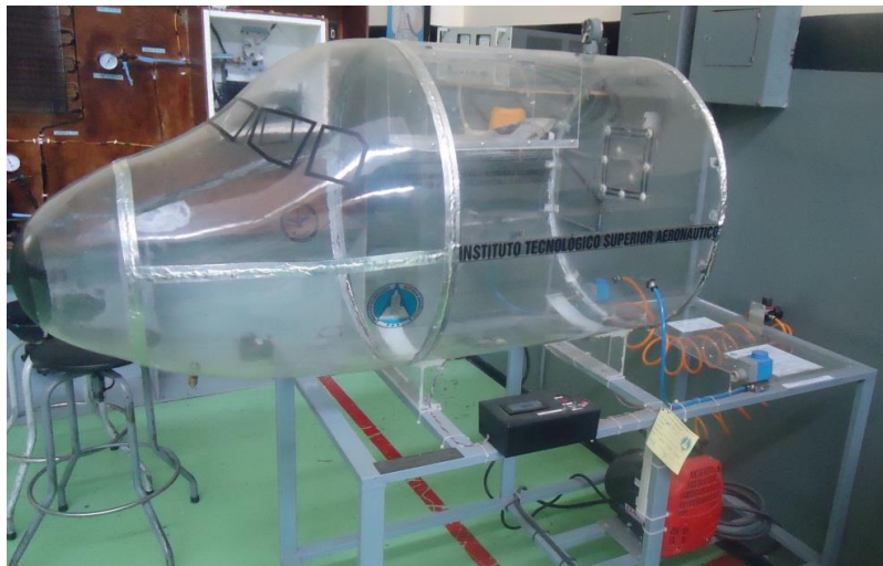
Fig. 30.- Sistema de Presurización Fuente: ITSA Bloque N°42
