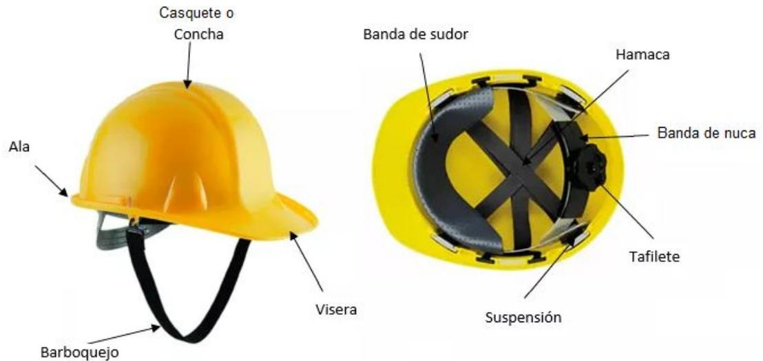
**Figura 22** Componentes de un casco de seguridad
