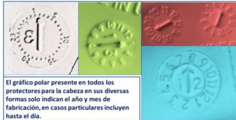
**Figura 38** Gráfico polar con fecha de fabricación del casco
