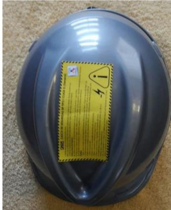
**Figura 23** Casco de seguridad Tipo I con certificación
