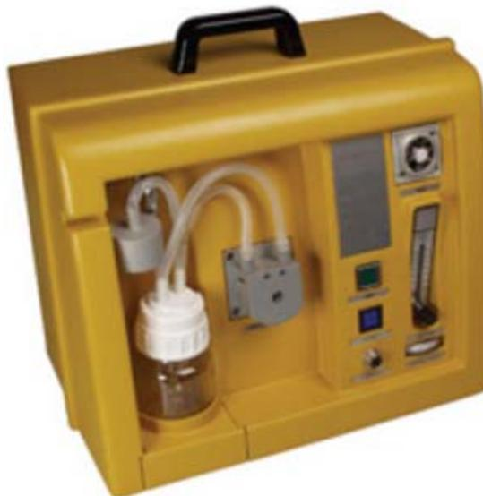
**Figura 6** Equipo de muestreo de aire
