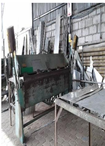
*Figura 20.* Dobladora de Planchas de Acero.
