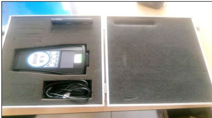
*Figura 3.* Luxómetro marca Spectronics Corporation
