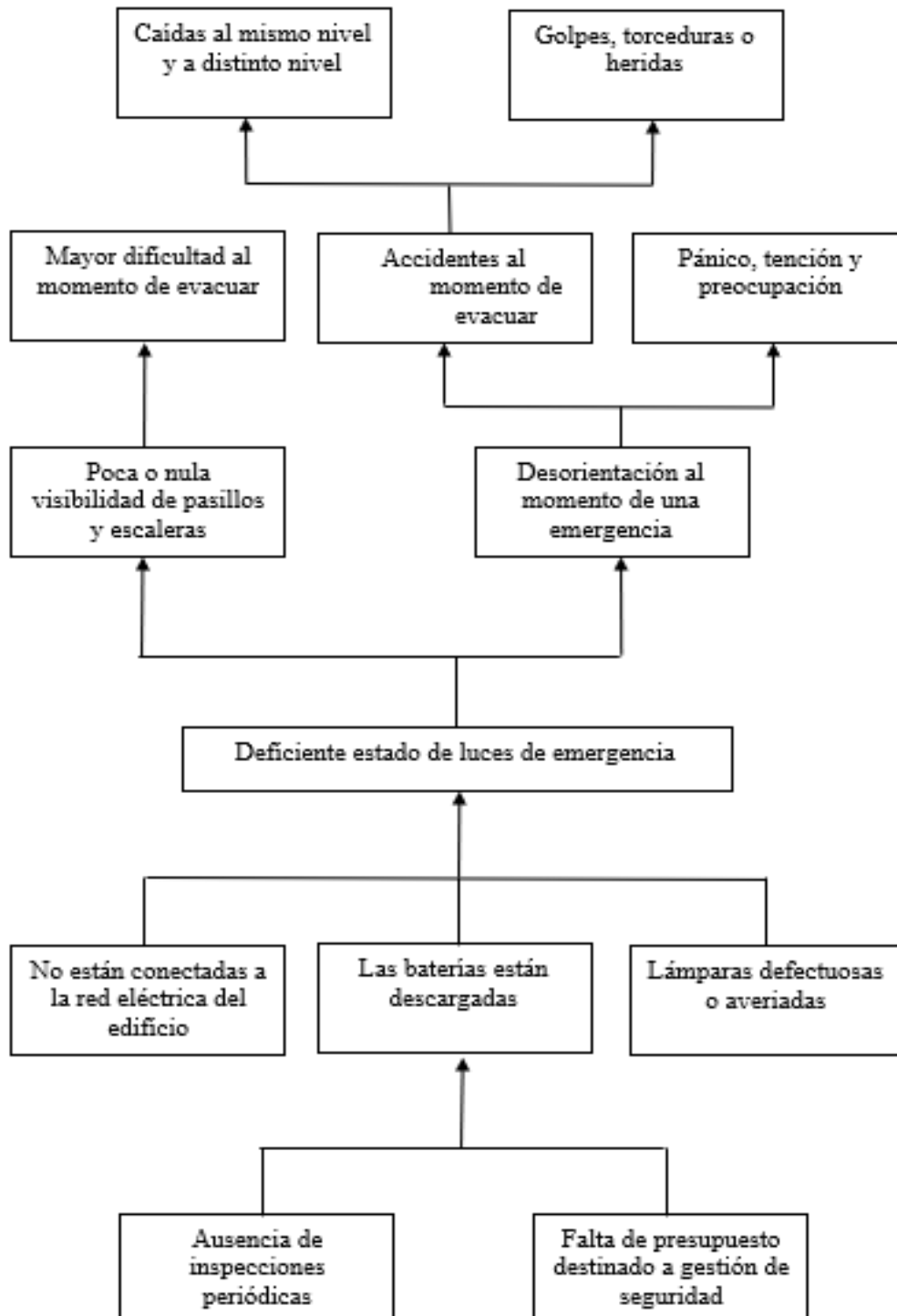
Figura 26. Árbol de problemas de luces de emergencia del Centro de Salud #1
