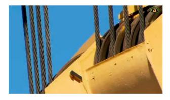
Nota: Elemento utilizado en forma de helicoidalmente para el izaje de carga. Tomado de (Gruas y Maniobras Perú, 2017)
