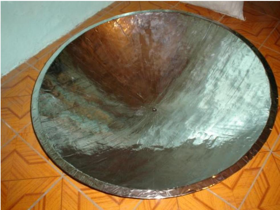
**Fotografía 5.6: Concentrador parabólico terminado**
