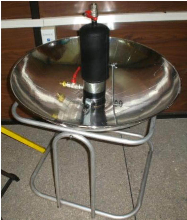
**Fotografía 2.10: Concentrador parabólico**
