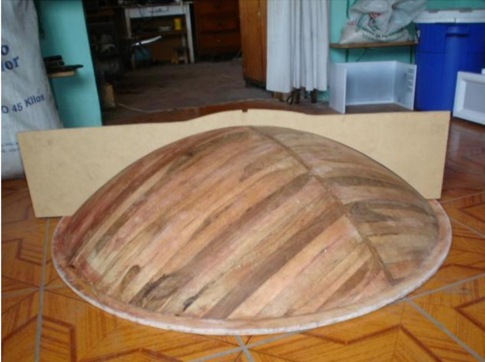
**Fotografía 5.5: Galga de verificación y molde terminado**
