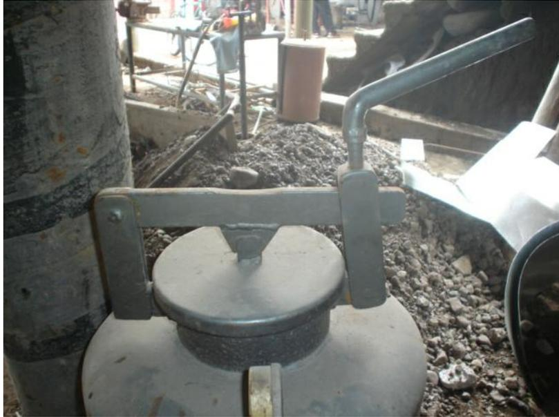
**Fotografía 4.1: Sistema de cierre hermético en un generador de gas a partir de carbón de piedra**
