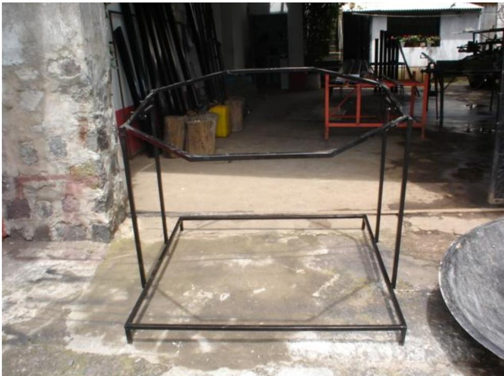
**Fotografía 5.8: Estructura soporte terminada**
