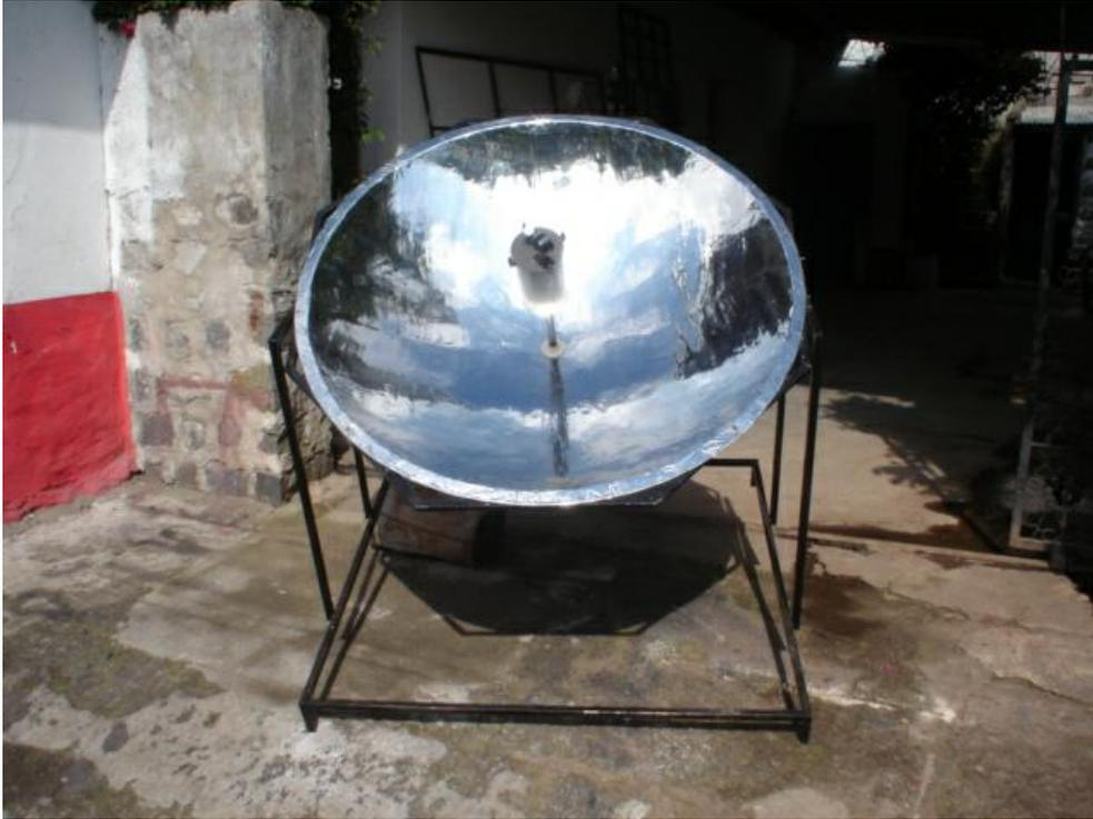
**Fotografía 5.9: Vaporizador solar terminado**
