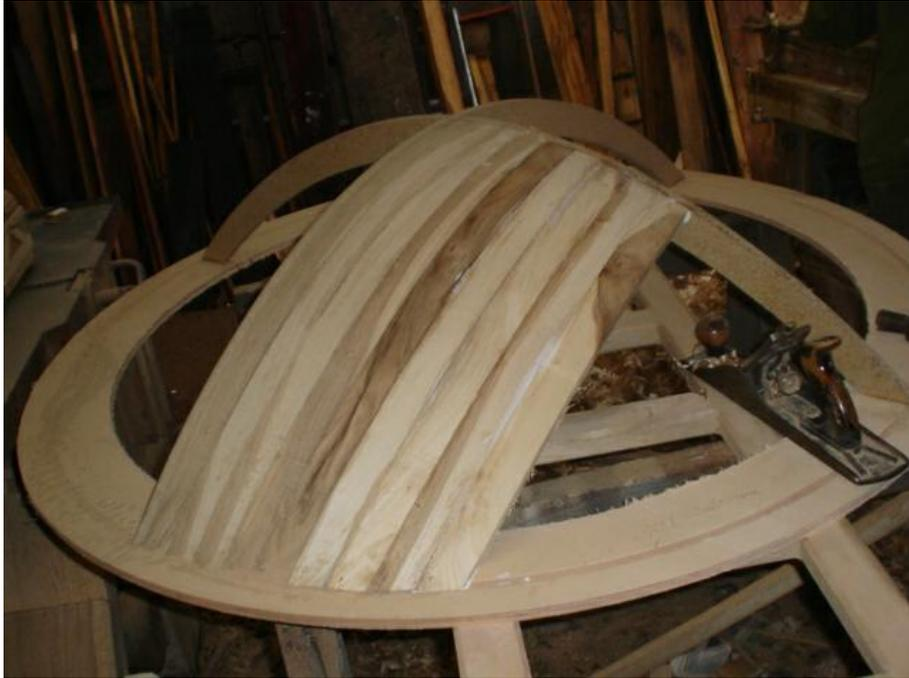
**Fotografía 5.2: Conformado de las tiras parabólicas del molde**
