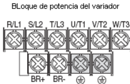
Figura 6.4 Bloque de Potencia
