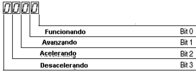
Figura 6.7 Estado del Variador
