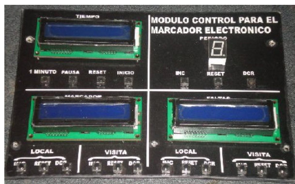
Figura 3.22 Placa de control del marcador electrónico (PCME).
