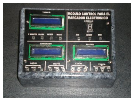
Figura 3.18 Módulo de control.
