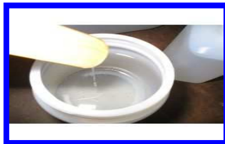
Ilustración 31.- Mezcla de la resina con el acelerante
