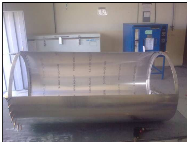
Figura 2.65: División del revestimiento.
