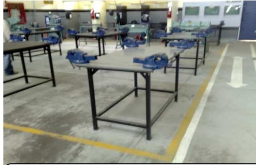
SEÑALIZACIÓN DE BORDE DE MESAS DE TRABAJO.
