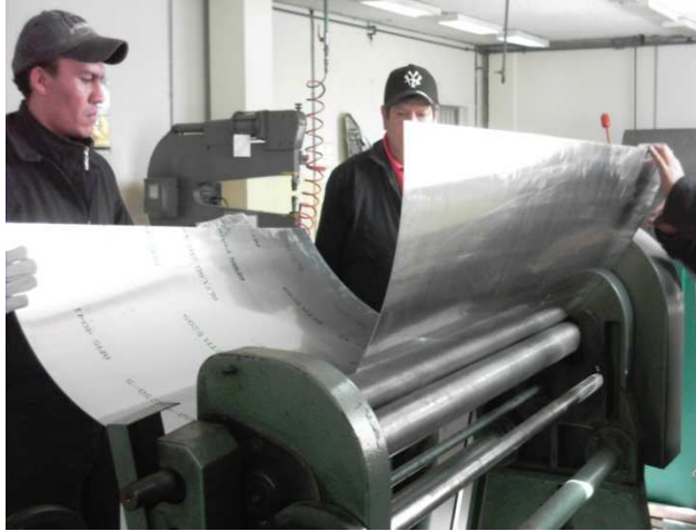
Figura 2.62: Formación del revestimiento en la baroladora.
