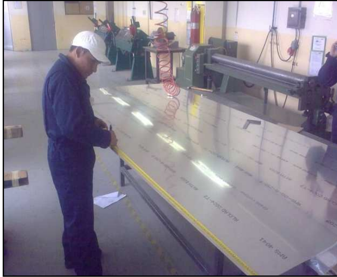
Figura 2.56: Lámina de Alclad aluminio 2024-T3; 0.40.
