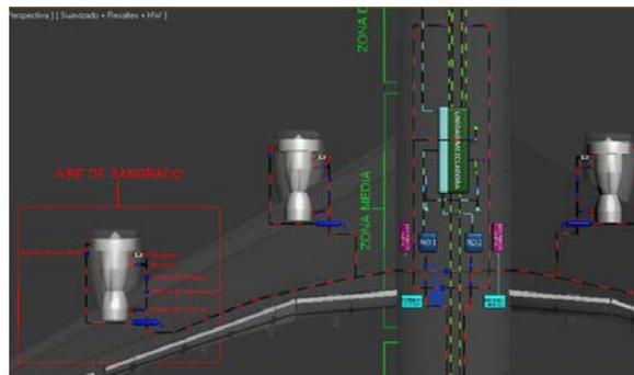
**Figura 3.21.** Diagrama final del sistema de aire acondicionado
