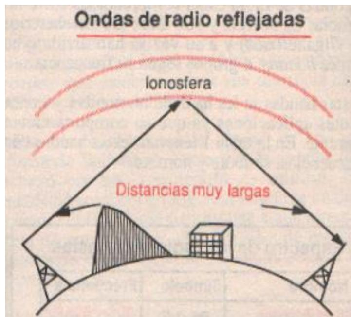
**Figura 2.4** Ondas de radio reflejadas
