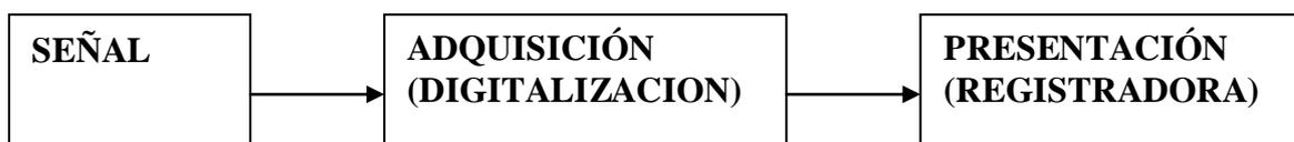
**Fig. 2.1 Diagrama de bloques de un sistema de instrumentación**
