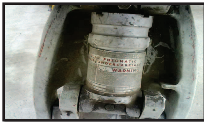
Figura 2.13 Amortiguador Absorbente del Tren de Nariz
