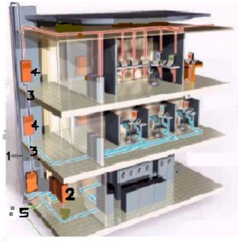
Fig. 2.2 Elementos físicos y cableado
