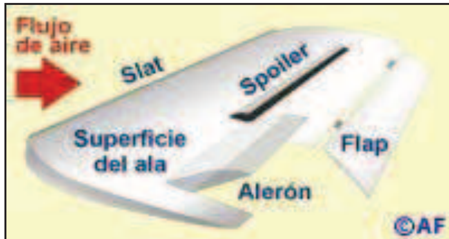
Anexo A4. Img. Superficies flexibles principales situadas en las alas de los aviones
