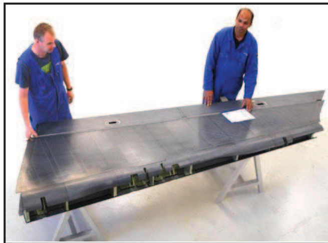
Anexo A11. Img. Soporte para controles de vuelo
