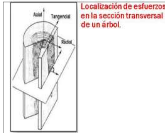
Figura 2.15. Localización de esfuerzos en un árbol
