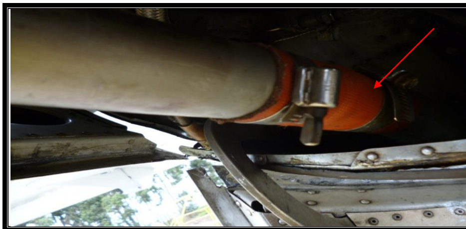
Figura 3.27: Conexión Engine Breather Line Elaborado por: Valeria Alulima
