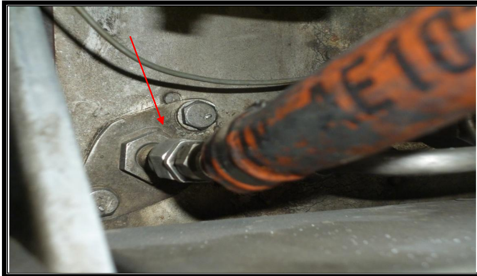
Figura 3.28: Conexión de Low Pressure Line
