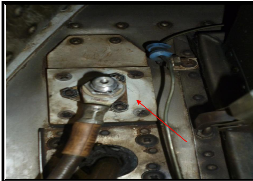
Figura 3.15: Conexión feathering pump (power)
