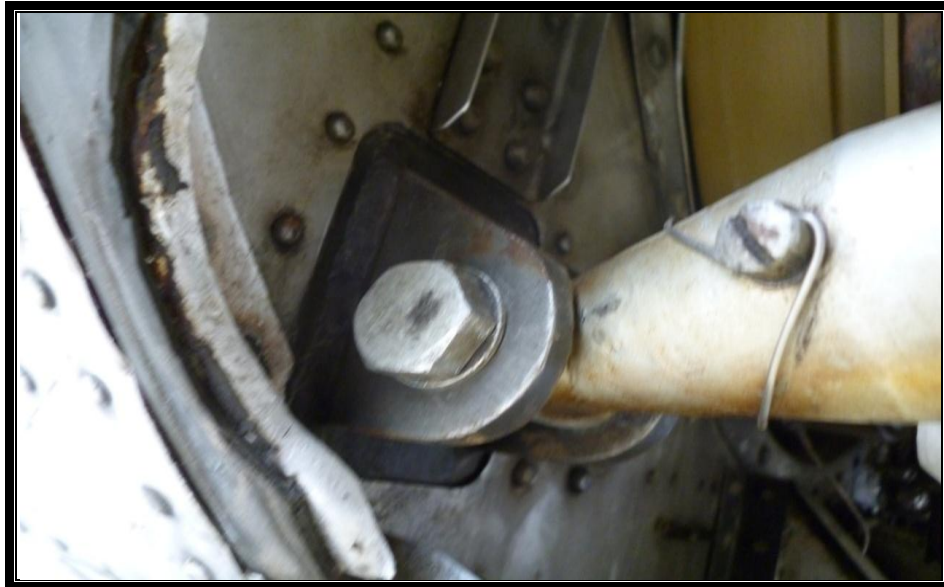
Figura 3.12: Punto de sujeción del Motor
