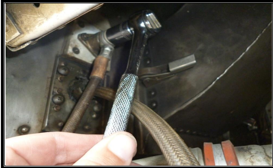
Figura 3.16: Momento de conexión de la Feathering pump Elaborado por: Valeria Alulima
