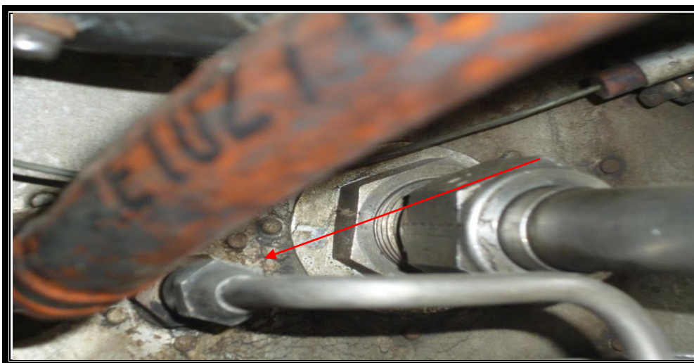
Figura 3.29: Conexión Aft Drain Line
