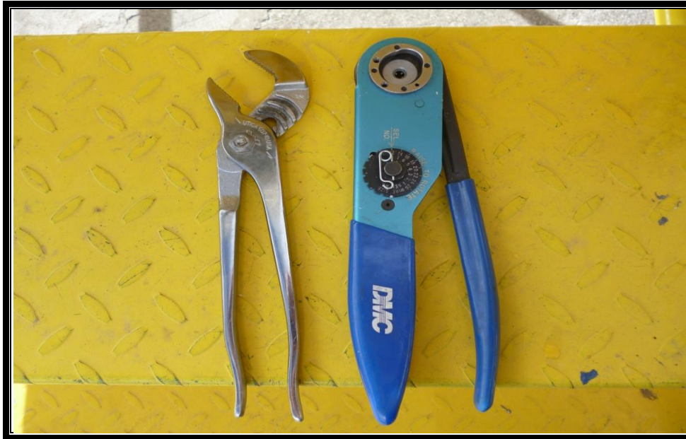
Figura 3.24: Herramientas para la conexión de plugs eléctricos Elaborado por: Valeria Alulima
