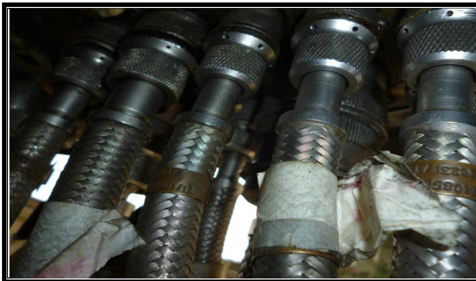
Figura 3.23: Conexión Prop Converter Controller Harnesses
