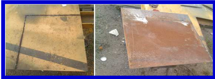
Figura 3.4.3.- Corte de lámina de tool para base del coche
