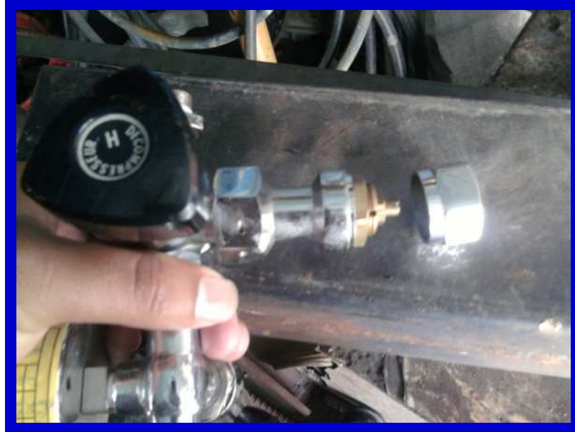
Figura 3.2.6.- Limpieza del área de purga
