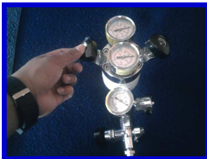
Figura 3.2.1.- Equipo de oxígeno gaseoso
