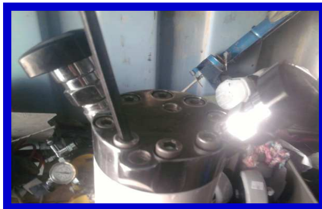
Figura 3.3.5.- Extracción de la cubierta del regulador
