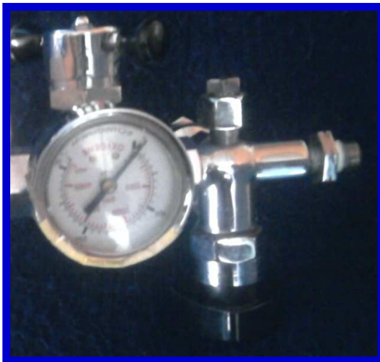
Figura 3.3.4.- Manómetro de alta presión
