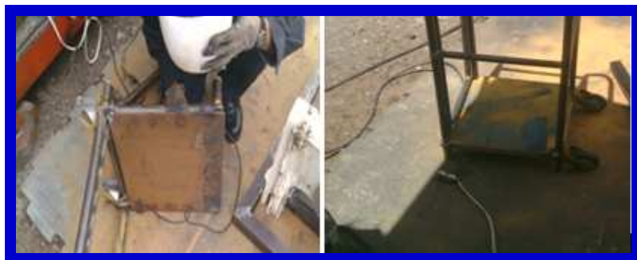
Figura 3.4.4.- Recubrimiento con lámina de tool
