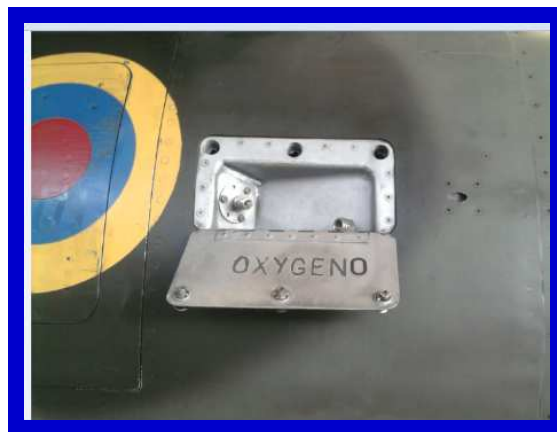
Figura 2.12.- Toma para llenado de oxígeno gaseoso del avión M-50
