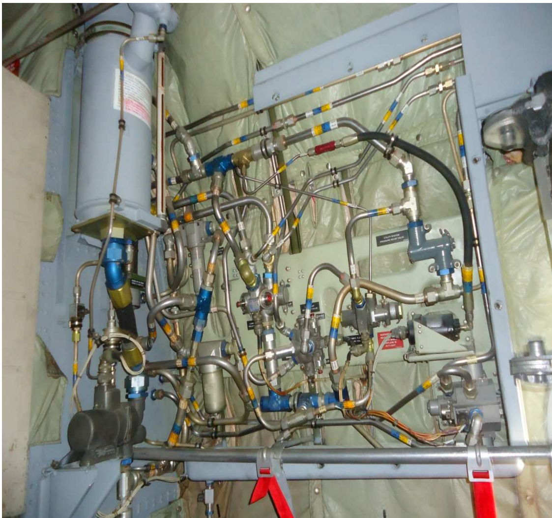
Figura 2.2.1 Sistema Hidráulico Utilidad
