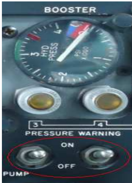
Figura 2.3.5 Interruptor de la bomba del motor Fuente: Avión FAE 892 C - 130 Elaborado por: Muñoz William
