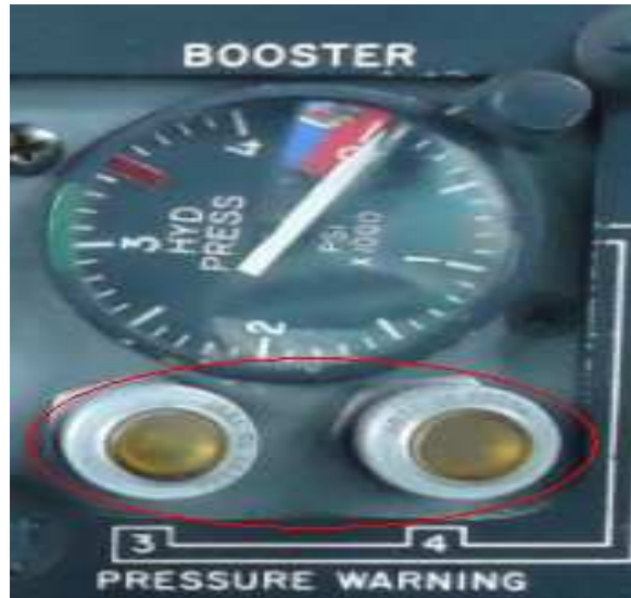
Figura 2.3.6 Luces de advertencia de presión de la bomba del motor Fuente: Avión FAE 892 C - 130 Elaborado por: Muñoz William
