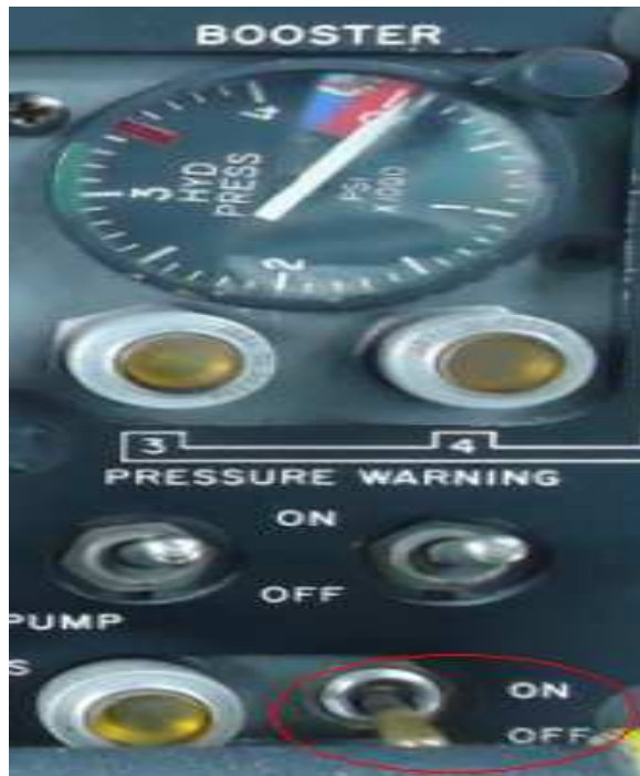
Figura 2.3.3 Switch de bombeo de refuerzo de succión booster Fuente: Avión FAE 892 C - 130 Elaborado por: Muñoz William
