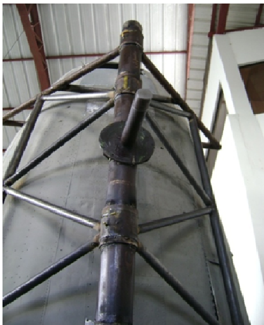
Figura 3.56: Estructura de acople de la cabina.
