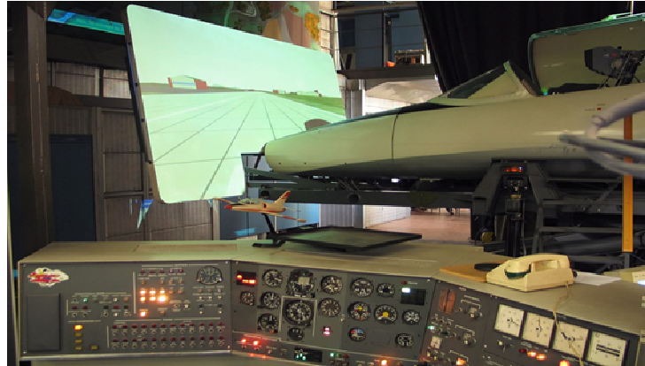
Figura 2.6: Simulador de movimiento TL39 3-Do.
