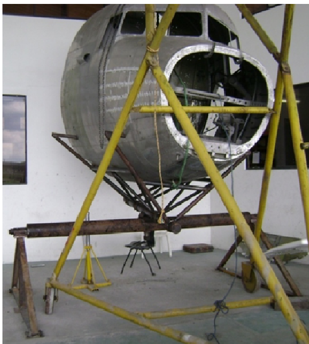
Figura 3.57: Estructura simuladora de movimientos totalmente ensamblada.
