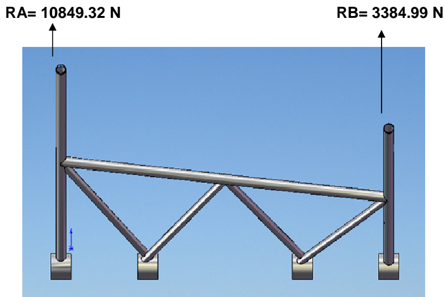
Figura 3.6: Reacciones de estructura de acople de la cabina. Fuente: Investigación de campo.
