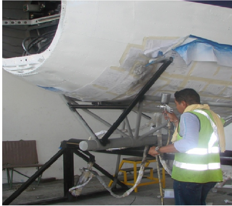
Figura 3.59: Proceso de pintado de la estructura color negro.
