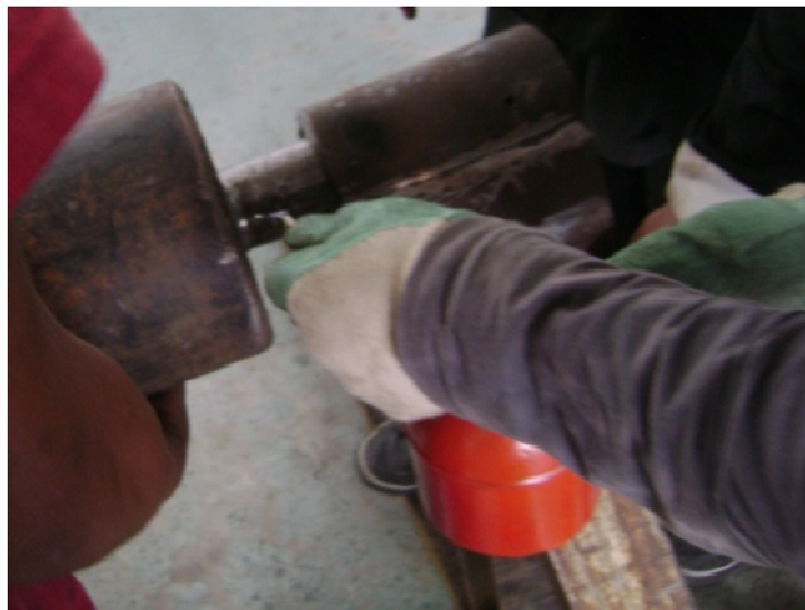
Figura 3.55: Introducción del eje en el bocín de la estructura base.
