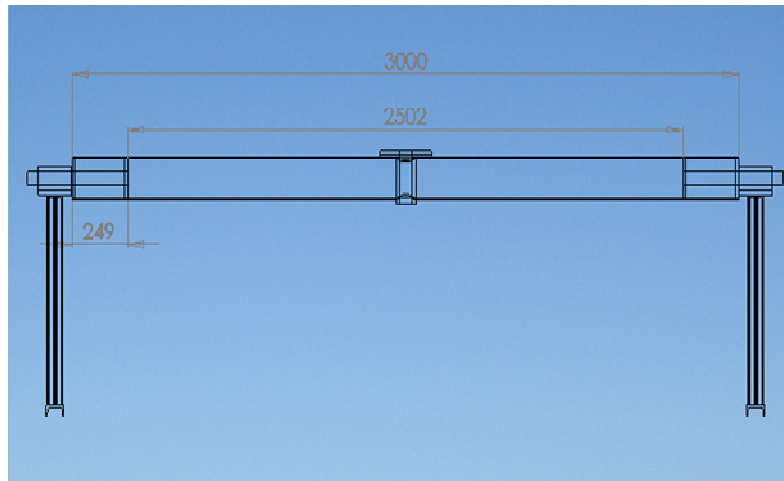
Figura 3.29: Dimensiones de la viga principal.
