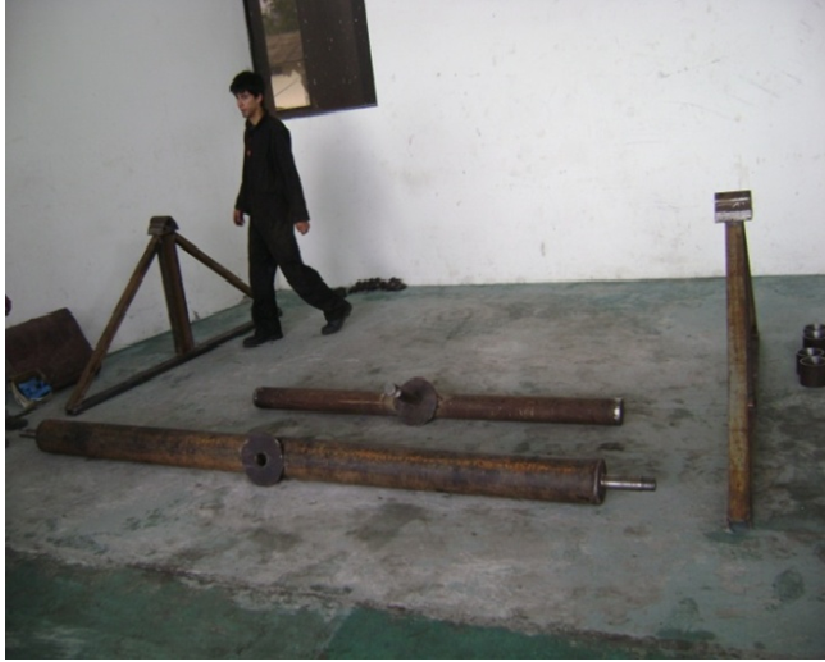
Figura 3.54: Posicionamiento de las bases laterales.
