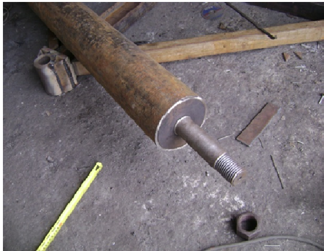
Figura 3.47: Colocación del eje para las bases laterales.
