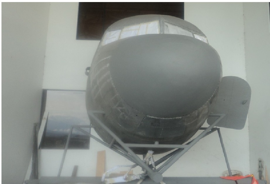
Figura 3.58: Estructura simuladora de movimientos fondeada.
