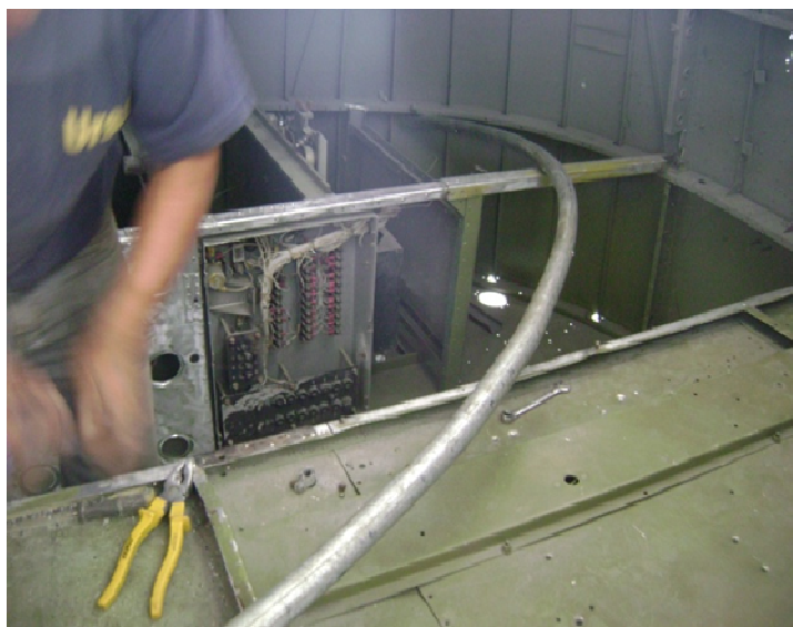
Figura 3.50: Refuerzos de la cabina con tubo galvanizado.
