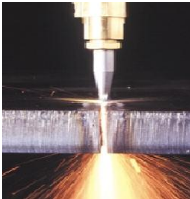
Fotografía 2.2 Proceso de Oxicorte (Foto tomada de PRAXAIR S.A.)
