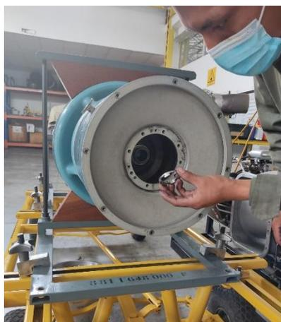
*Nota:* La arandela de fricción se afloja para el lado derecho y se ajusta para el izquierdo.
