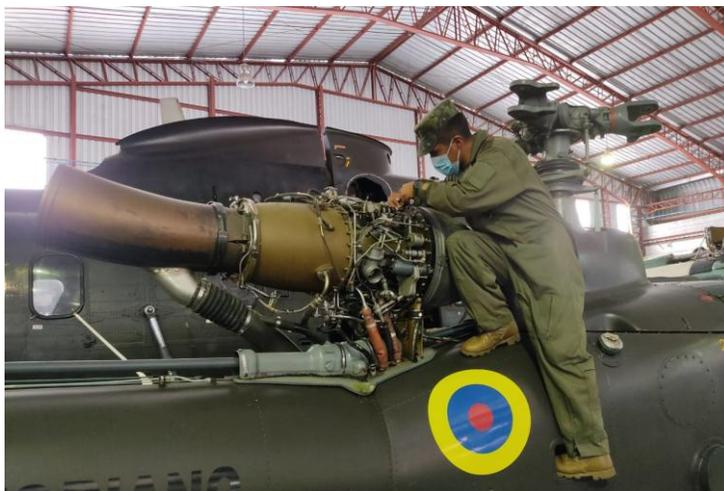
*Nota:* Desmontaje de cada uno de los indicadores de presión y temperatura del motor.
