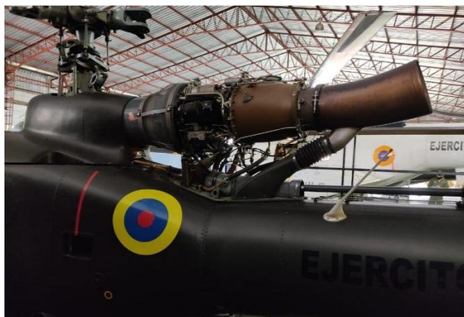
*Nota:* Motor Astazou XIV-H instalado sobre el helicóptero Gazelle.
