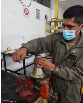
*Nota:* Montaje de la arandela de fricción de la toma de potencia.
