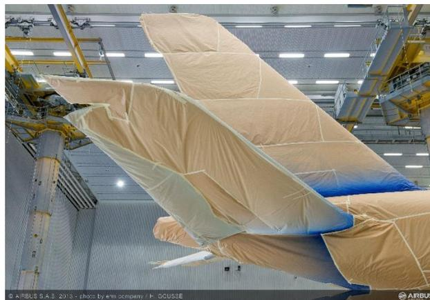
*Nota.* Se debe enmascarar todos los materiales que estén compuestos de micas, cauchos o materiales compuestos. Tomado de (Armendáriz, 2019)
