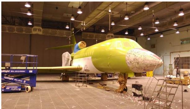
*Nota.* La aeronave está cubierta con una capa de primer. Tomado de (Sora Templates, 2017)
