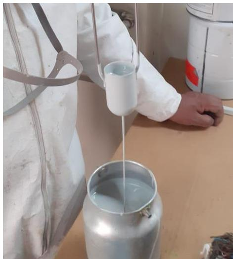
*Nota.* El medidor de viscosidad se lo realiza mediante el vaciado del mismo y el tiempo se lo mide en segundos, para este tipo de pintura se deberá vaciará en un lapso de 18 a 22 segundos.
