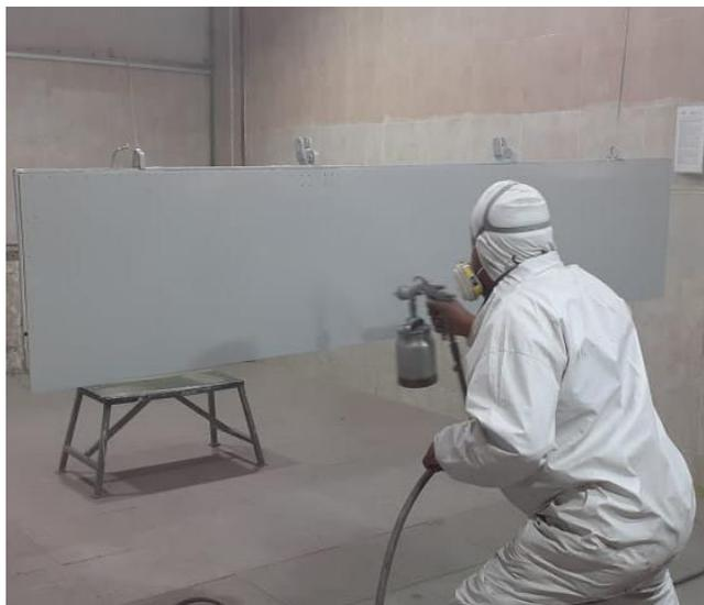
Al culminar el proceso de pintado se lo deberá tener en reposo sin manipulación y a puerta cerrada de la cabina de pintura aproximadamente por 2 días en este tiempo la pintura tendrá el curado necesario para poderlo manipular.
