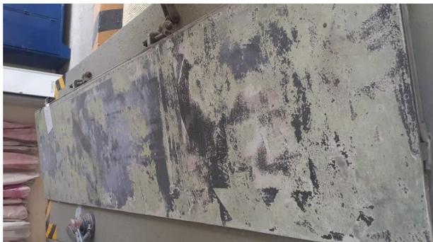
*Nota.* En la imagen podemos observar el spoiler de vuelo asignado para realizar la tarea de mantenimiento
