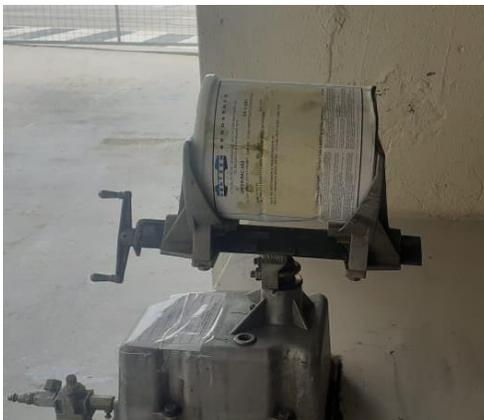
4. Concluida la agitación de la pintura continuamos con el siguiente paso que es la mezcla de la pintura entre la base y el catalizador, de igual manera la proporción de estos dos componentes es de 1/1 en porciones iguales.
