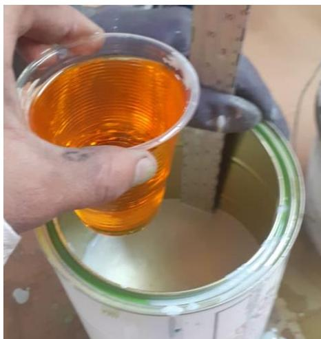
5. Como siguiente paso tenemos poner la mezcla de la pintura en el envasé de la pistola, una vez que la pintura este en el envase procedemos a realizar la prueba de viscosidad de dicha pintura, se lo realizará utilizando la copa ZAHN misma que nos permitirá saber si la viscosidad es la correcta.
