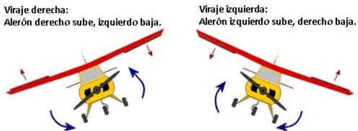
*Nota.* Movimiento en el eje longitudinal. Tomado de (Dert-16, 2013)
