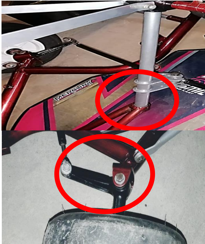
Columna de dirección y mangueta unido al chasis.
