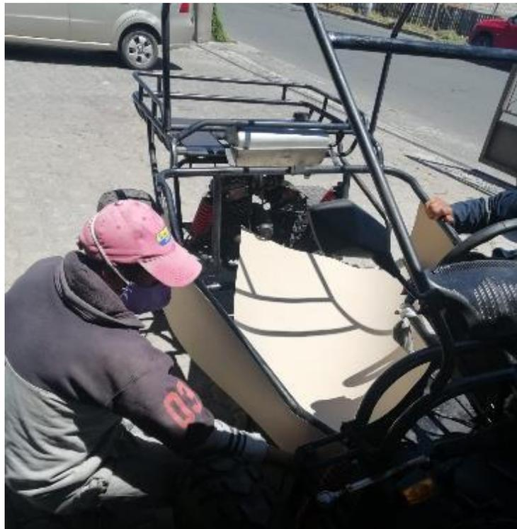
*Nota.* Se puede notar el método que se utilizó para poder elaborar los moldes respectivos para poder construirlos con materiales compuestos
