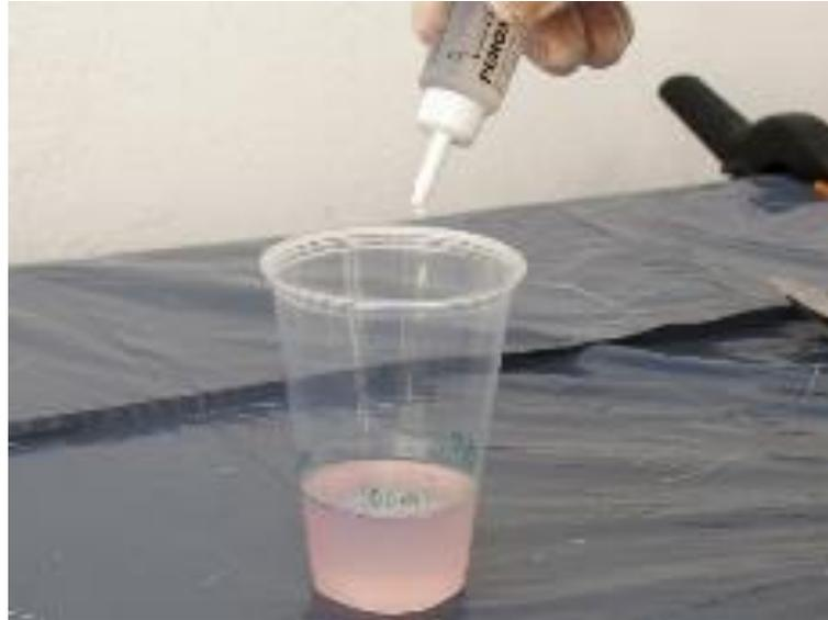
*Nota.* En la imagen se puede identificar como se debe mezclar correctamente la resina, porciones según fabricante. Tomado de (Bricolaje, 2010)
