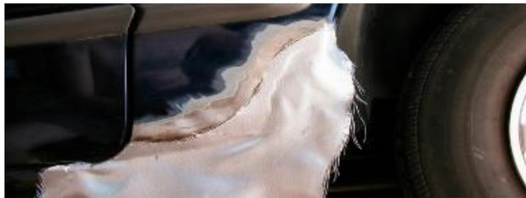
Nota. en la imagen se puede identificar a la fibra de vidrio cortada. Tomado de (Motorex, 2018)
