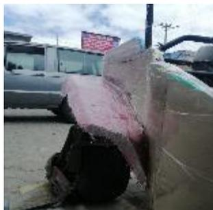
*Nota.* A continuación, se identifica el guardafango ya terminado y listo para el proceso de lijado y masillado.
