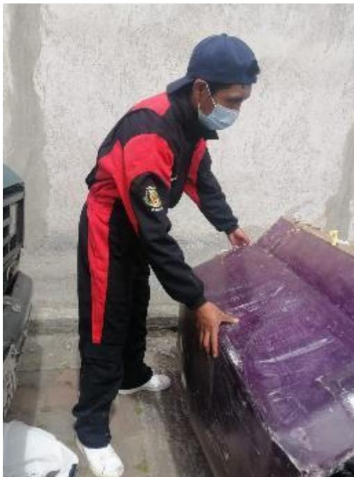
*Nota.* Se puede ver a los moldes en fibra de vidrio listos para ser lijados y masillados.
