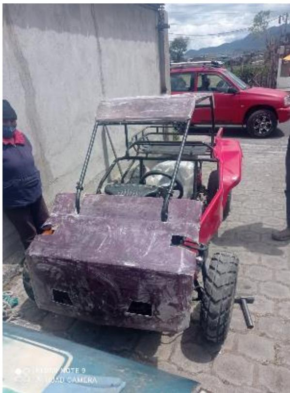
*Nota.* Se puede ver a los moldes en fibra de vidrio y carbono lijados y masillados listos para poder pintarse.
