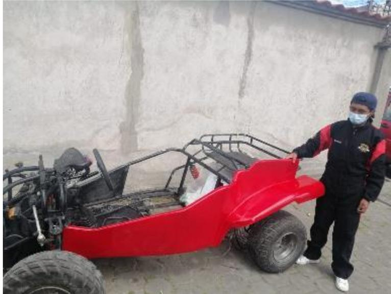
*Nota.* Se puede ver a los moldes en fibra de vidrio próximos a instalarse
