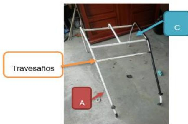
*Nota.* se aprecia la estructura de la cabina con sus respectivos componentes como travesaños, montante A y C.
