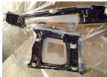
*Nota.* en la figura que se muestra se puede ver como es el proceso final de la elaboración de un objeto en fibra de vidrio mediante el proceso con resina. Tomado de (Pedro, 2016)
