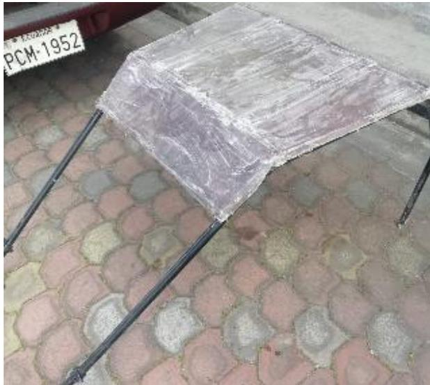
*Nota.* En la imagen que se muestra a continuación se puede ver a los moldes en fibra de vidrio y carbono para la parte del techo.
