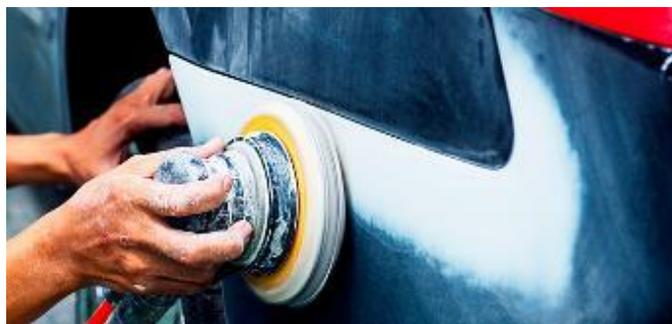
*Nota.* en la imagen se observa cómo se debe lijar la superficie de fibra de vidrio y resina totalmente secos. Tomado de (Motorex, 2018)
