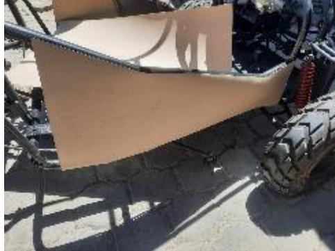
*Nota.* Se puede notar el método que se utilizó para poder elaborar los moldes respectivos para poder construirlos con materiales compuestos.
