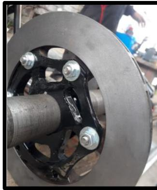
*Nota.* Se monta el disco en la base la cual irá instalada en el eje de transmisión.
