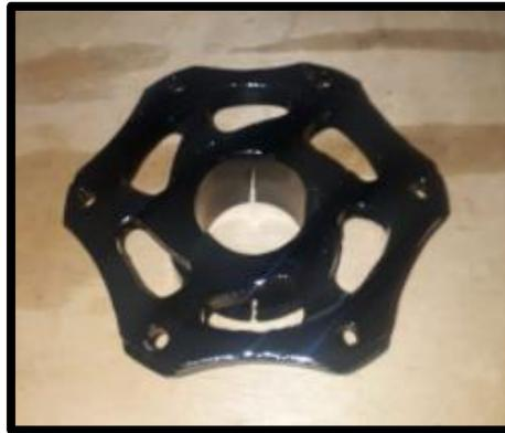
*Nota.* Resistente a la torsión y es donde el disco de freno se coloca para ser montado en el eje de transmisión
