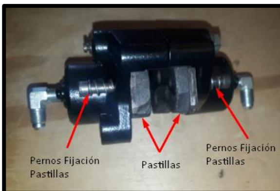
*Nota.* Fijación de pastillas y localización dentro de la pinza de frenos.
