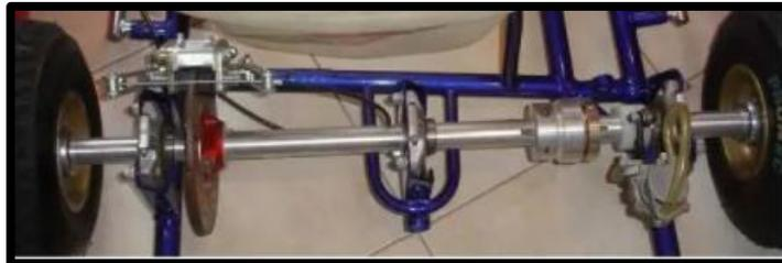
*Nota.* Vista superior del eje trasero con el anclaje en el bastidor. Toma de (Análisis de Gokart, pág. 29)
