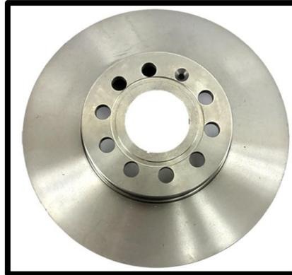
*Nota.* Se puede observar que el disco no posee ningún tipo de separación o perforación.
