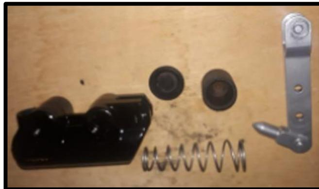
*Nota.* Se observa las partes que conforman la bomba del sistema de freno los cuales son pistón, palanca de accionamiento, reten, muelle y el cuerpo.
