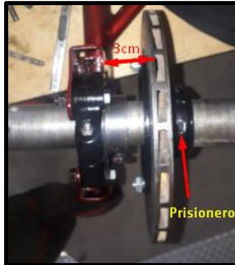
*Nota.* Se aprecia la distancia entre el punto base asía el disco de freno, adicional se observa la ubicación del prisionero de la base del disco de freno.
