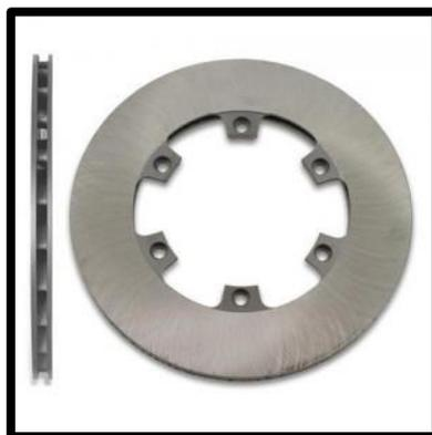
*Nota.* Vista frontal y lateral del disco de freno a utilizar en el sistema de freno.
