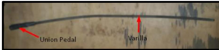
*Nota.* Se observa el punto de unión con el pedal y la sección que une con la bomba.
