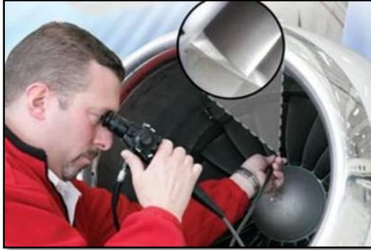
*Nota.* El grafica representa la inspección visual que realiza un técnico de mantenimiento para tener un diagnóstico rápido, simple y confiable. Tomado de visual inspection Aviation (2007, 6 junio). AviationPross.
