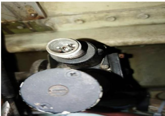
*Nota.* La limpieza de conectores se debe realizar con WD-40 que es el líquido específico para ese tipo piezas.
