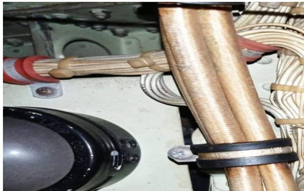
*Nota.* Identificamos las abrazaderas que se encuentren corroídas y realizamos su remplazo.
