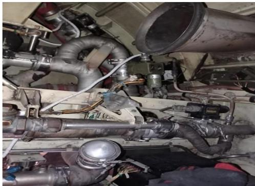
*Nota.* Realizamos la limpieza y verificación que el cableado no se encuentre expuesto a contaminantes como virutas de metal.
