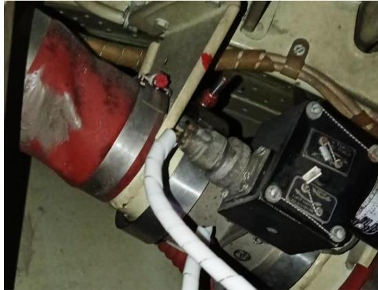
Nota. Observación del estado de los bucles de goteo para conectores eléctricos.
