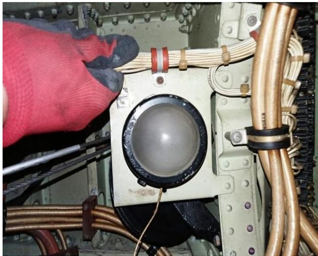
*Nota.* Examinar que las abrazaderas sean del tamaño acorde al mazo de cables para que no puedan ocasionar daños.
