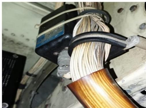
*Nota.* Examinamos el estado y la ubicación de las abrazaderas en el sistema.
