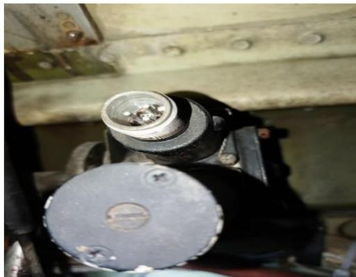
Nota. Verificación que en la parte interna del conector no se encuentren pines sueltos o dañados.
