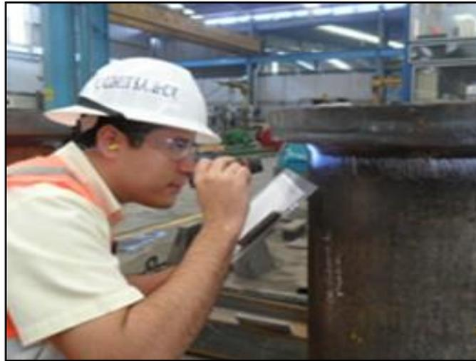
*Nota.* En este grafico podemos observar cómo se realiza una inspección directa con la ayuda de una linterna y los datos específicos del manual. Tomado de Universidad Tecnológica de Pereira. (s. f.). inspección visual en aviación.
