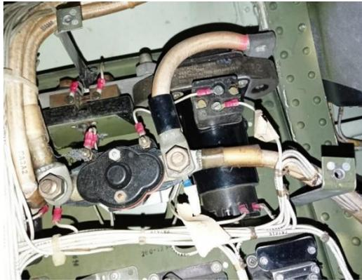
*Nota.* Es importante verificar el ajuste de los terminales para evitar daños o desconexiones en los mismos.
