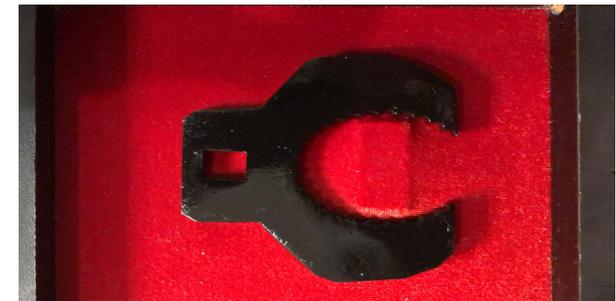
Se construyo la herramienta, ya que en la donacion de la aeronave, no se entrego ninugna herramienta especial, para la realizacion de inspecciones.
