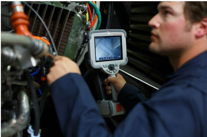
Se utilizan en programas de mantenimiento de motores y aviones para reducir o eliminar la necesidad de costosos de desmontajes tales como :
