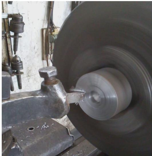
*Nota:* Esta imagen representa el torneado del eje dentado para acoplarlo al material de soporte.
