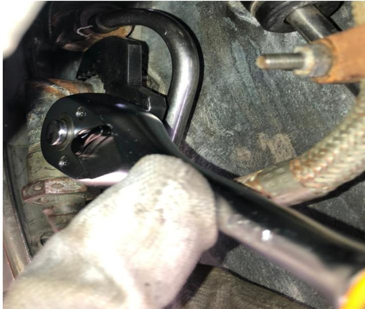
*Nota:* En la imagen se muestra la remoción de la tuerca de la bujía con el uso del trinquete para realizar la inspección por boroscopia
