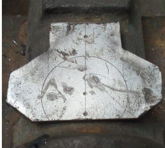
*Nota:* Esta imagen representa el dibujo de la forma de la herramienta especial para ser mecanizada y remover las bujías de los motores.
