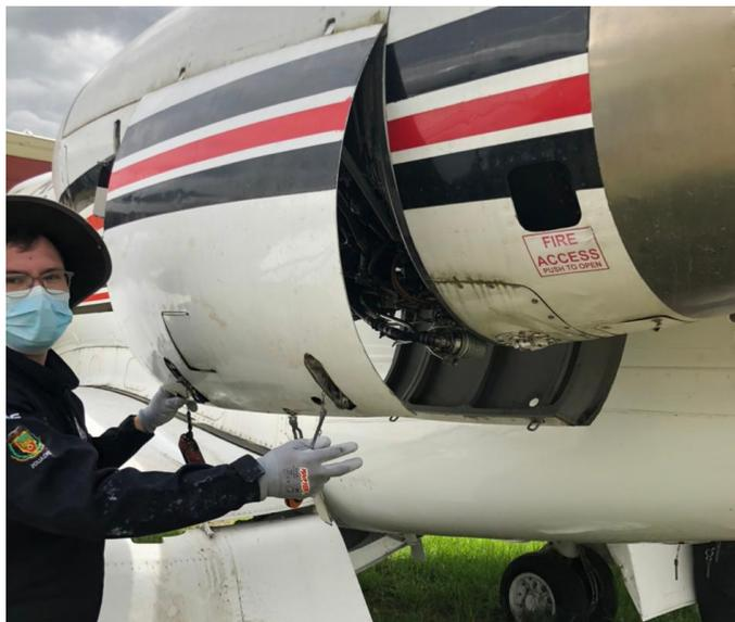
*Nota:* El grafico muestra la remoción de la cubierta inferior para obtener acceso al puerto de la bujía del motor.
