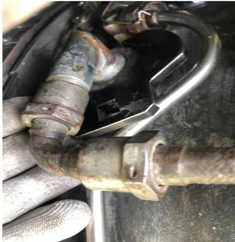
Nota: En esta imagen se aprecia la remoción de la tuerca de la bujía con el uso del trinquete para realizar la inspección por boroscopia
