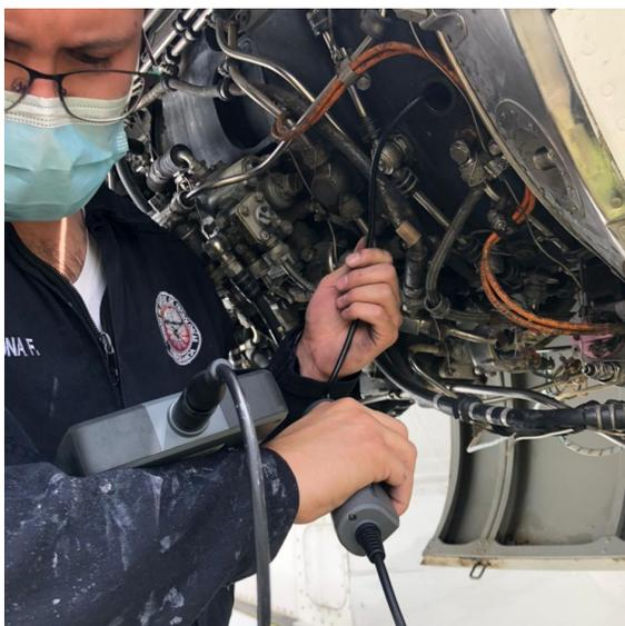
*Nota:* Esta imagen representa la inserción de la sonda en el puerto de la bujía para ejecutar la inspección de la sección central interna del motor.
