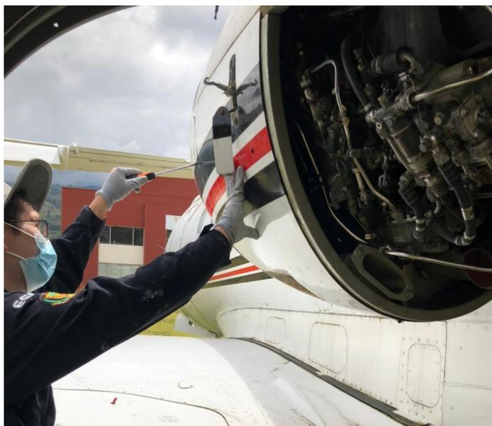
*Nota:* Esta imagen representa la remoción de la cubierta inferior delantera para obtener mayor movilidad en la inspección del motor.
