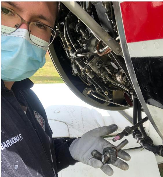
*Nota:* Esta imagen representa como se encuentra removida la bujía del motor izquierdo para que ingrese la sonda del boroscopio para la inspección.
