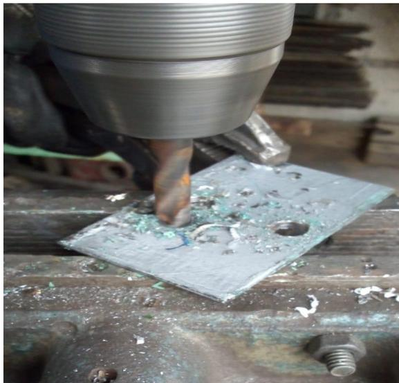
*Nota:* Como se aprecia en la imagen la mecanización por perforación de puntos adecuados previo al corte del material.
