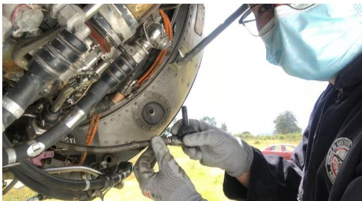
*Nota:* Esta imagen representa como se encuentra removida la bujía del motor derecho para que ingrese la sonda del boroscopio para la inspección.
