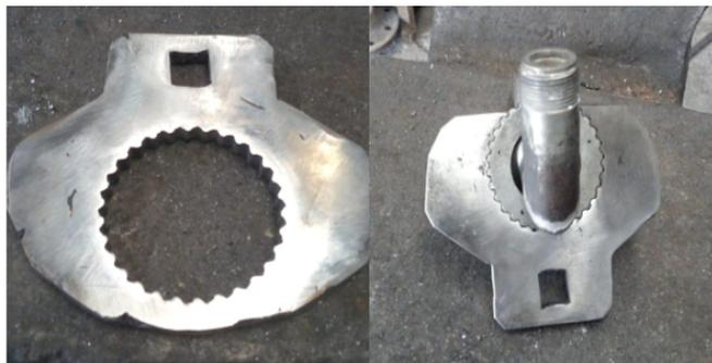
*Nota:* Esta imagen representa la herramienta especial terminada y comprobada en la tuerca de la bujía para ser probada en las áreas de los motores.
