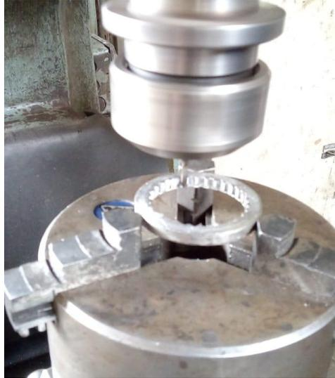
*Nota:* Como se aprecia en esta imagen el fresado del eje dentado de la herramienta especial para remover la tuerca de la bujía.
