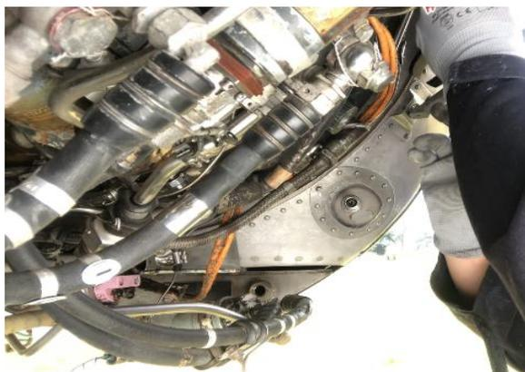
*Nota:* Como se observa en la imagen el trabajo de remoción de cañerías y cables para acceder al puerto de la bujía que va ser removida
