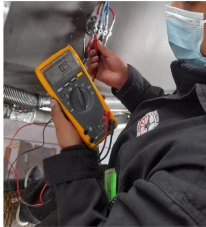
*Nota:* La fotografía representa resultado obtenido en el punto de la resistencia de la caja de conexión de las termocuplas.
