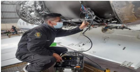
*Nota:* El gráfico representa el proceso del cable de conexión de las señales.
