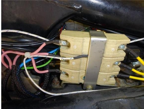
*Nota:* El grafico representa un ballast que sirve para medir la resistencia de los cables del circuito de una termocupla. Tomada de (KZ1300.COM, s.f.)
