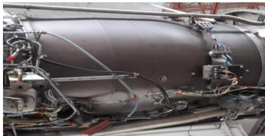
*Nota:* El gráfico representa a la desconexión de los bornes de la caja de conexión de las termocuplas
