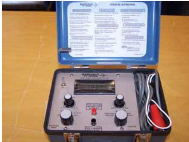
*Nota:* El gráfico indica un equipo de prueba de EGT. Tomado de (Calibration, 2017)
