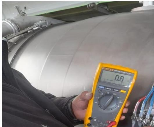
*Nota:* El gráfico representa a los resultados obtenidos de la resistencia del control de los cables de las termocuplas del motor Rolls-Royce.
