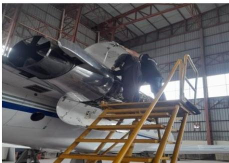
*Nota:* El gráfico representa el deslizamiento de las capotas del motor
