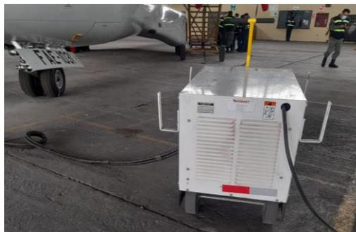
*Nota:* La fotografía representa a la conexión de la fuente de alimentación a avión Gulfstream II.
