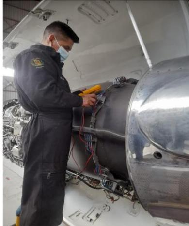
*Nota:* El gráfico representa a la medición de resistencia del control del circuito del cable de las termocuplas del motor.
