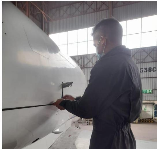
*Nota:* El gráfico representa el cierre de las capotas del motor después de la inspección realizada.
