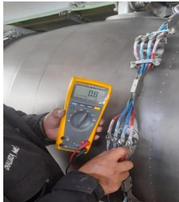
*Nota: EL gráfico representa la medición de los datos de la resistencia del control de límites de los cables de la termocupla.*
