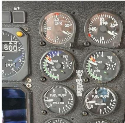
*Nota: La grafica se muestra el indicado de TGT en la cabina del avión Gulfstream II.*
