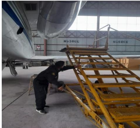
*Nota:* El gráfico representa la colocación de la escalera hidráulica para realizar la inspección de la termocupla del Motor Rolls-Royce Spey 511-8.
