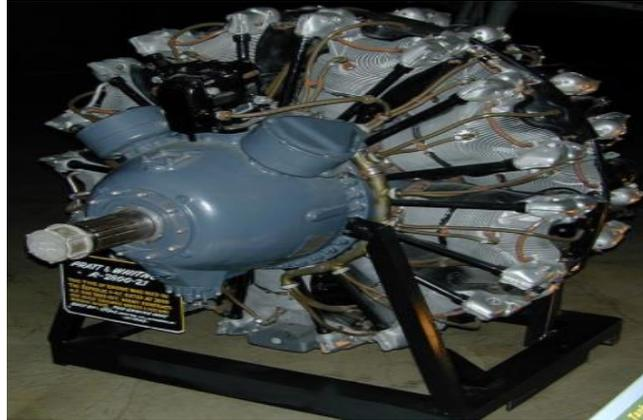
*Nota:* La figura muestra el motor radial de la segunda guerra mundial. Tomada de (funciona, 2021)
