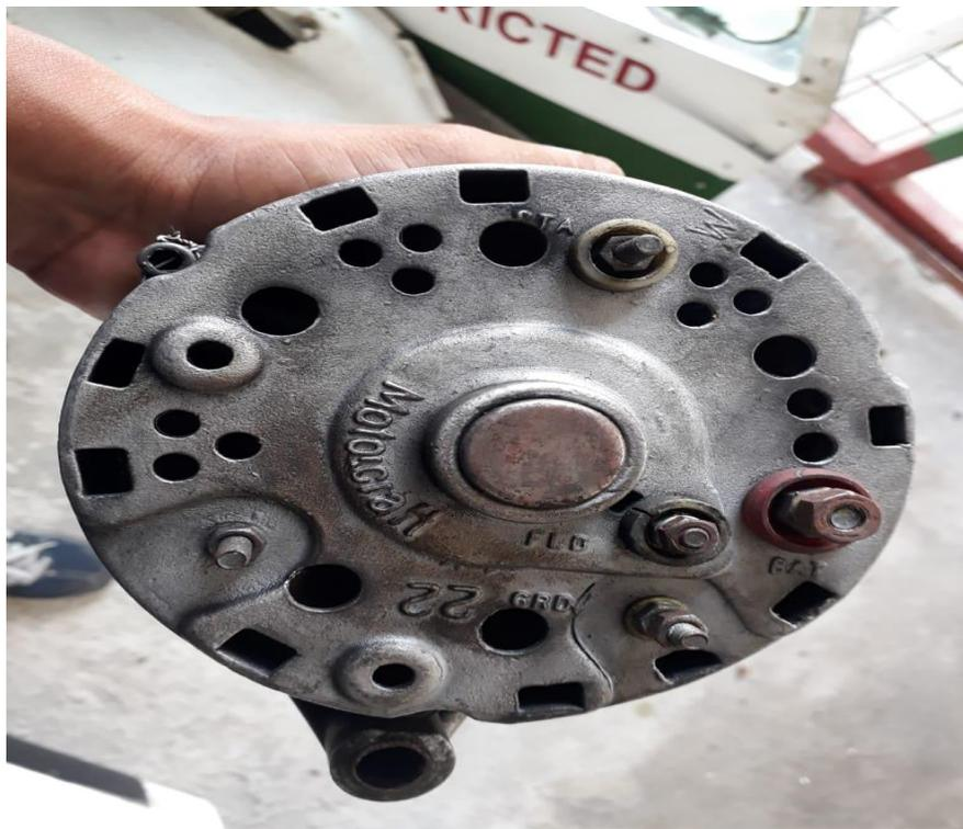
*Nota:* La figura muestra las conexiones del alternador como: conexión a tierra, positivo y el de batería.
