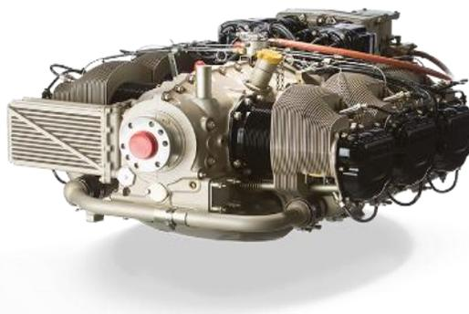
*Nota:* Se puede observar en esta figura el Motor Continental IO – 550 para la aeronave Cessna. Tomada de. (AEROSPACE, 2011)
