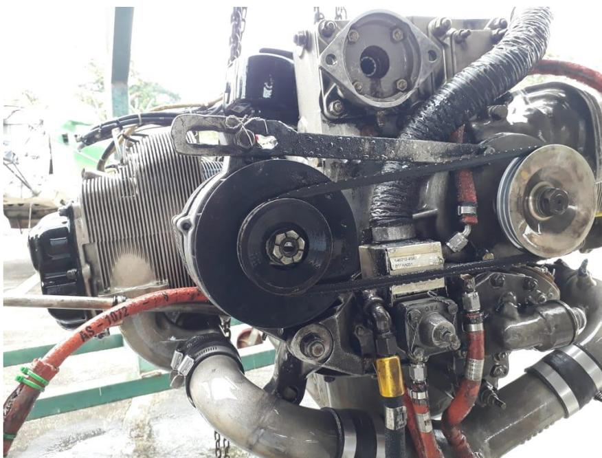
*Nota:* La figura muestra la instalación del alternador Kelly Aerospace en el motor Continental IO – 550 – 5 – 22.
