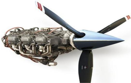
*Nota:* En esta figura se muestra el motor opuesto con su hélice. Tomada de. (volar, 2010)
