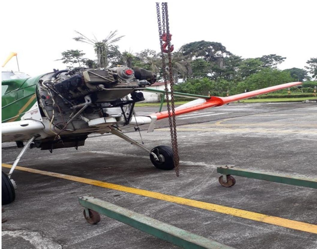
*Nota:* En la figura se puede mostrar el desmontaje del motor continental IO – 550 –D.
