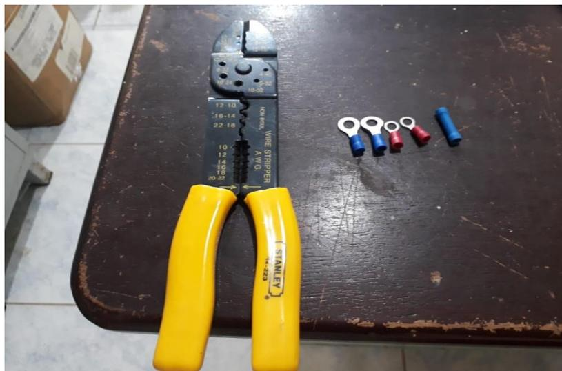
*Nota:* La figura muestra los terminales eléctricos que se procedió a cambiar en los cables
