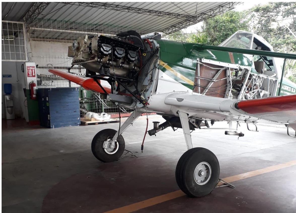
*Nota:* la presente figura muestra el motor de la aeronave Cessna T188 en la cual se va a cumplir la inspección del alternador Kelly Aerospace.
