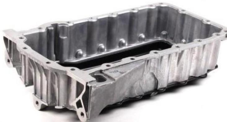
*Nota:* La presente figura muestra el cárter del motor. Tomada de (aviones, 2017)
