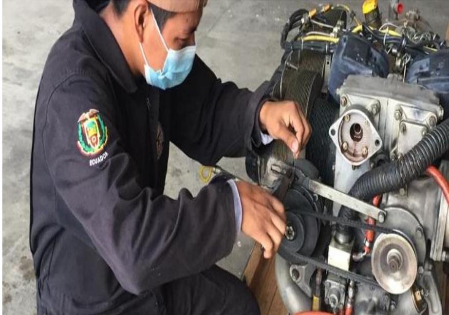
*Nota:* La presente figura muestra el corte del alambre de freno que va en el brazo que sujeta al perno.
