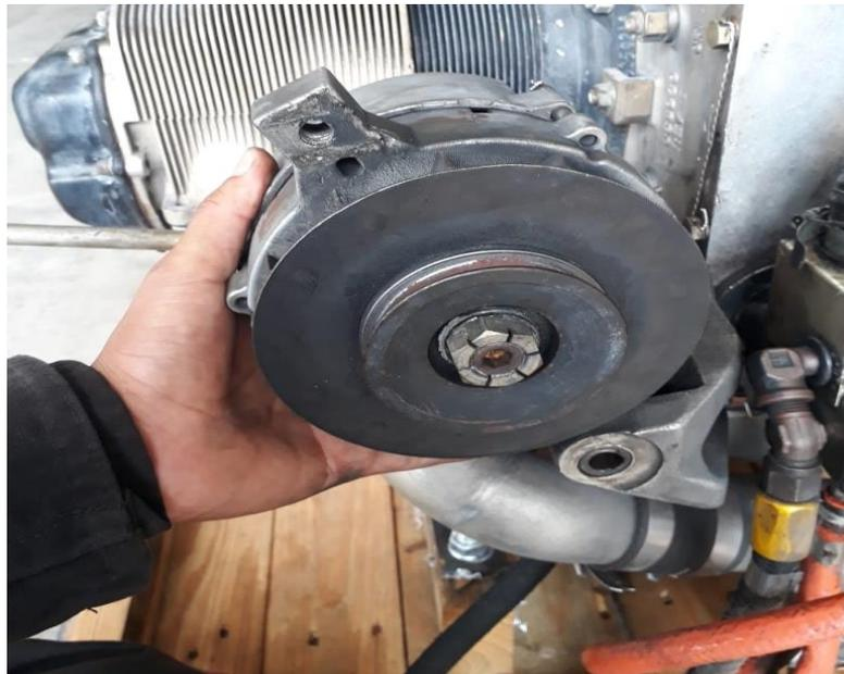
*Nota:* La figura presenta el montaje de los pernos de la parte superior e inferior que sujetan al alternador. Para realizar el desmontaje del alternador.
