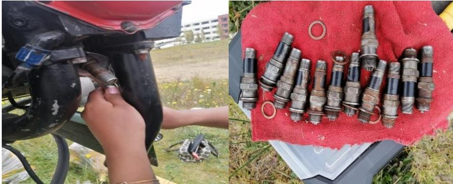
*Nota.* En la imagen se identifica las bujías extraídas del motor
