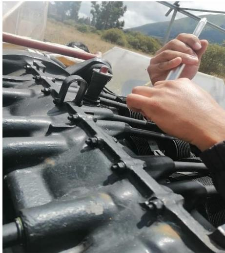
*Nota.* Se observa la extracción de las bujías
