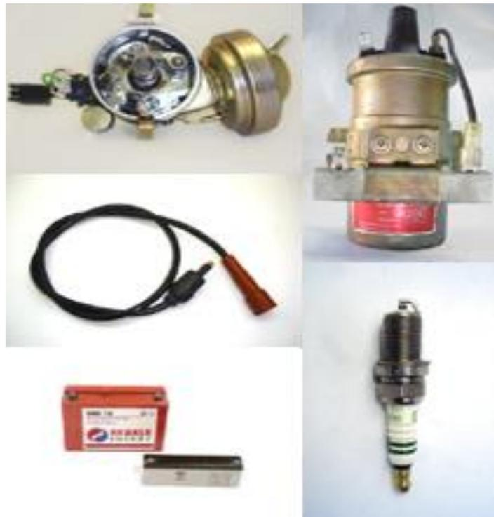
*Nota.* El gráfico representa todos los componentes del sistema de encendido
