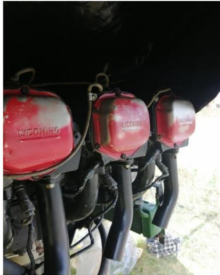
Nota: Se debe revisar uno por uno los cables de encendido que van conectadas desde los magnetos hacia las bujías que van conectadas o insertadas en cada cilindro, en total de revisión de cables son 12, si se nota suciedad en los mismos hay que proceder a limpiarlos con acetona y gasolina.
