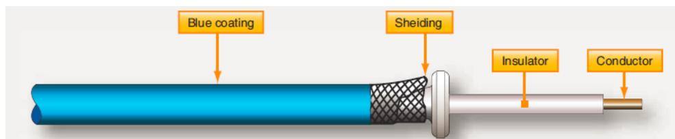
*Nota.* El gráfico representa un cable del arnés de ignición con sus partes internas y externas. Tomado de: (Aircraft C. R.,2003)
