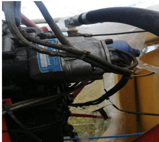
*Nota.* En el gráfico se identifica el magneto del motor
