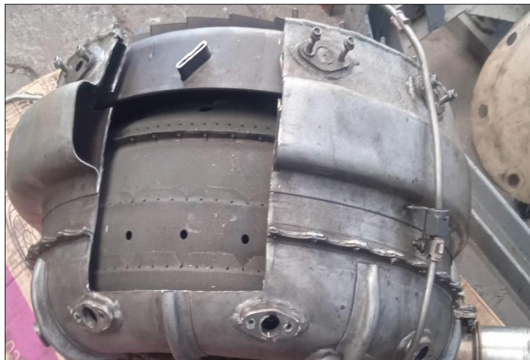
Cámara de combustión del Motor de Turbina de Gas AI-9V
