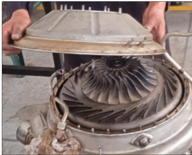
Compresor del Motor de Turbina de Gas AI-9V
