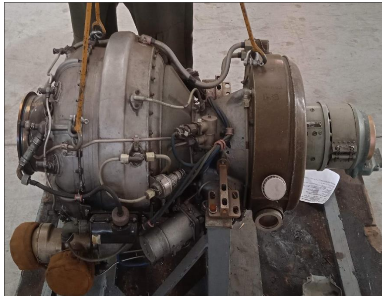
Cuerpo de accionamientos del Motor de Turbina de Gas AI-9V
