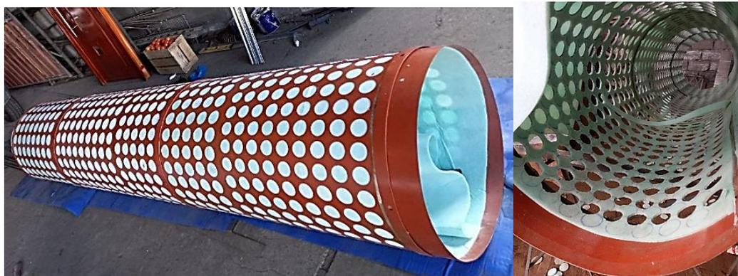
Con el recubrimiento protector mostrado en la Figura 117, el ingreso y salida de los tomates de riñón clasificados es satisfactoria y no sufren cortes ni aplastamientos los frutos, esto fue comprobado una vez revisados en las gavetas de salida.
