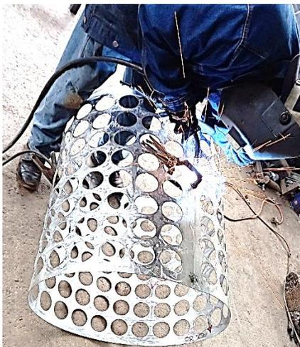
A continuación, se realiza el ensamble y armado de las 3 secciones diseñadas como se muestra en la Figura 97
