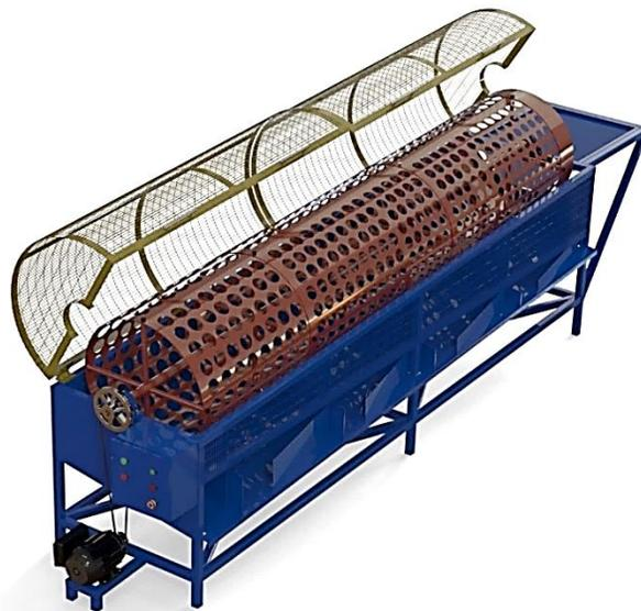
Como se muestra en la Figura 59, La máquina clasificadora puede clasificar hasta cinco diferentes tamaños de tomate de riñón (primera a quinta), las cuales son transportadas por la bandeja de salida y es diseñada con una ligera inclinación.
