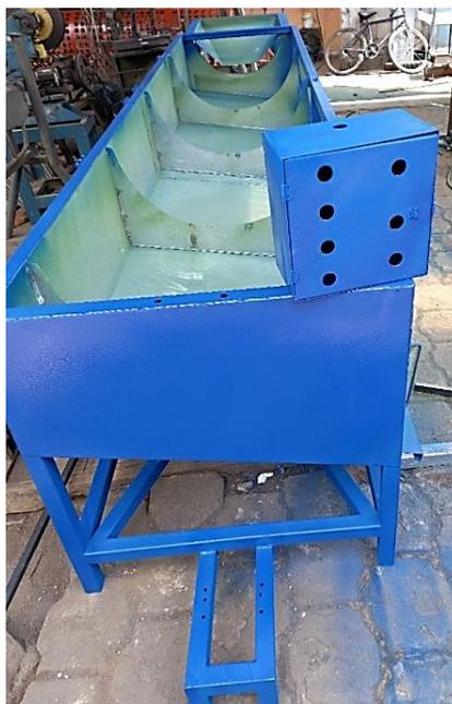
Finalmente, antes de ensamblar los elementos de la máquina clasificador de tomate de riñón, se procede a pegar con un pegamento especial llamado “Adhesivo en Spray Super 77™”, se adhiere una capa de un material esponjoso biodegradable, el cual ayuda a cuidar de cortes y aplastamientos en los frutos como se muestra a continuación en la Figura 104:
