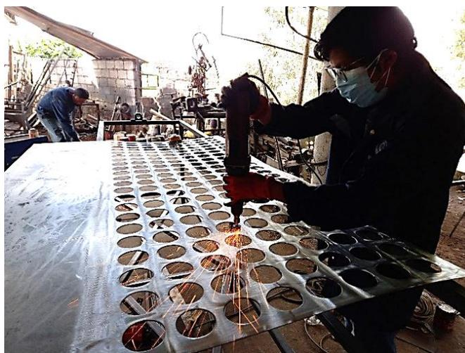
Es inevitable, realizar los acabados de pulido y limado de los orificios como se observa en las Figuras 94 y 95, ya que así salvaguardar que no se dañe el fruto de ninguna manera.
