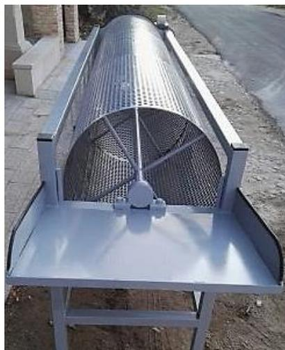
*Nota.* Se aprecia el sistema prototipo para clasificar frutos por cilindro giratorio. Tomado de (InfoAgro, n.d.).
