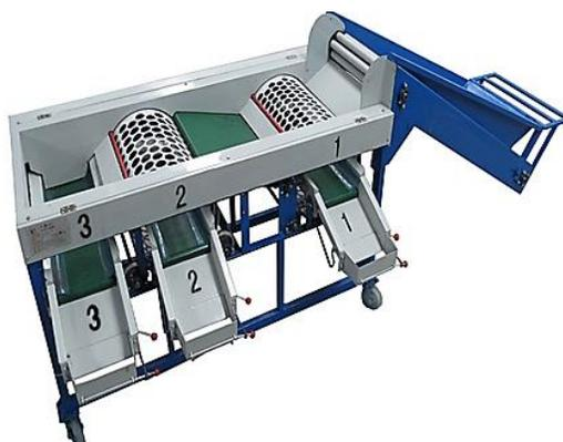
*Nota.* Se muestra un sistema clasificador por varios cilindros perforados giratorios para uso en frutos y hortalizas. Tomado de (*Pasen Machine*, 2009).
