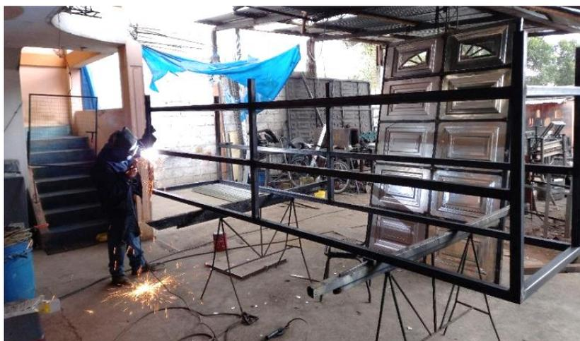
A continuación, en la Figura 92 se puede apreciar el armado final de la estructura de la máquina:
