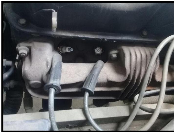
Figura 54 Cambio de bujías y arneses Fuente Propia
