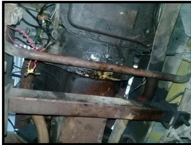
Figura 51 Caja de cambios en mal estado Fuente Propia
