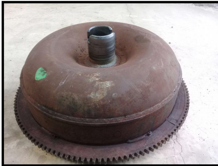
Figura 58 Conjunto del Volante de inercia y el convertidor de la caja de cambios Fuente Propia
