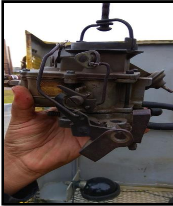
Figura 56 Carburador Fuente Propia
