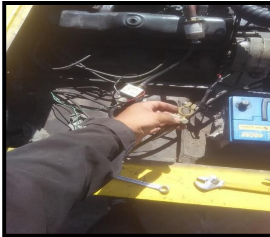
Figura 68 Conexión de Batería Fuente Propia
