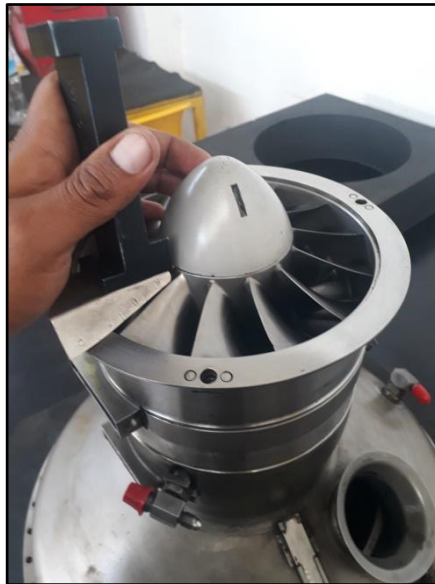
Figura 62 plantilla de control de erosión
