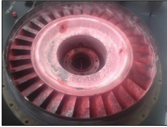
Figura 75 Verificación de los álabes de turbina
