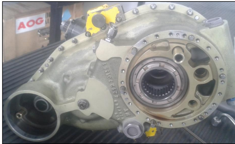
Figura 53 Inspección de ovalización en el M05
