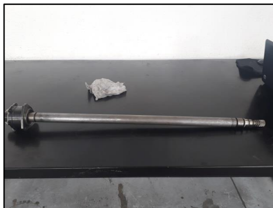
Figura 49 correcto estado del eje de potencia
