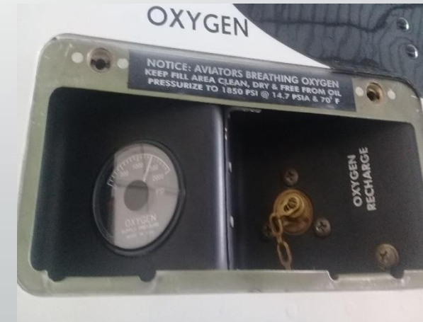
MANOMETRO Y VALVULA DE LLENADO
