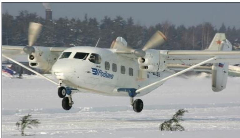
**Figura 14 Aeronave Antonov An- 28 con motores PT6**
