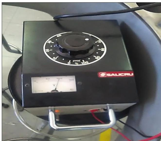
**Figura 43 Fuente de poder de voltaje variable**
