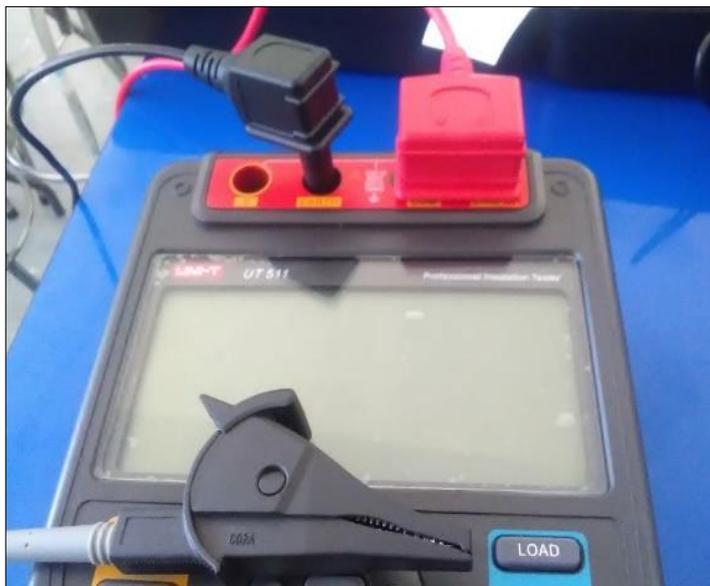
**Figura 24 Conexión COM LINE Y EARTH**
