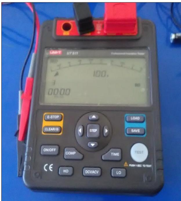
**Figura 35 Encendido del megger**
