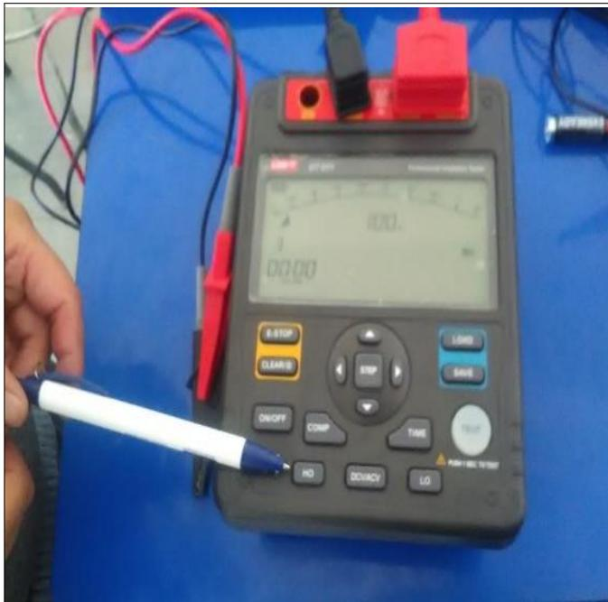
**Figura 26 Selección HO para medición de aislamientos**
