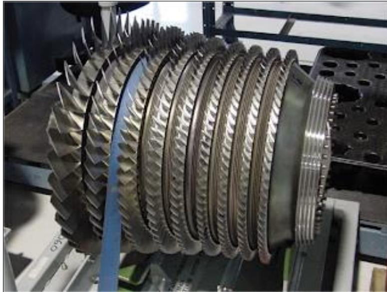
**Figura 3 Compresores Axiales**
