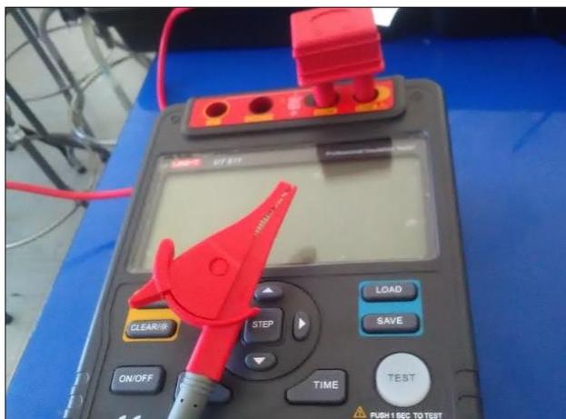
**Figura 33 Conexión COM LINE**
