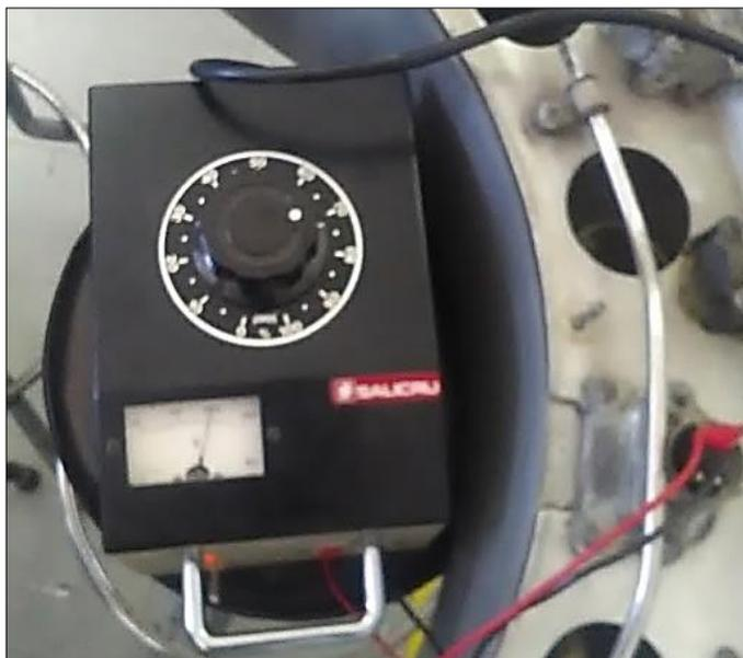
**Figura 45 Fuente calibrada con 100 voltios de salida**
