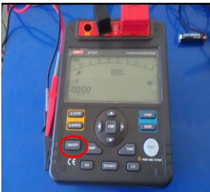
**Figura 25 Encendido del MEGGER**
