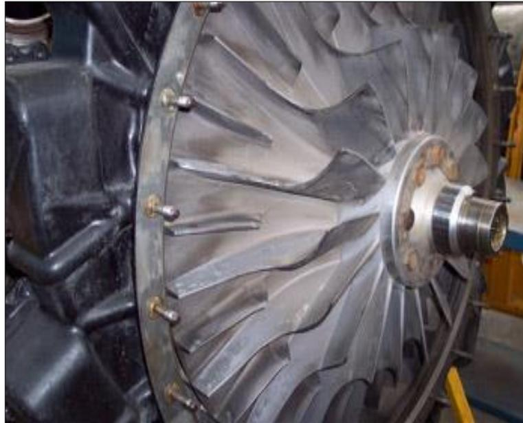
**Figura 2 Compresores Centrífugos**
