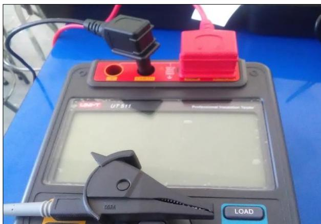
**Figura 34 Conexión COM LINE y EARTH**
