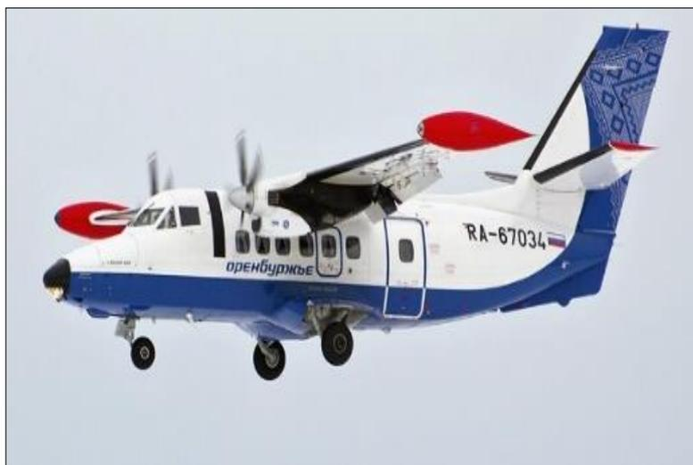
**Figura 12 Aeronave L-410 con motores M601**
