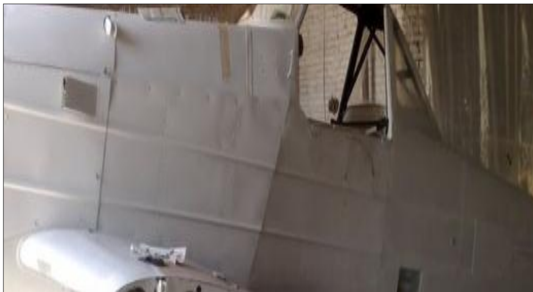
Figura 31 Aplicación del fondo en el fuselaje
