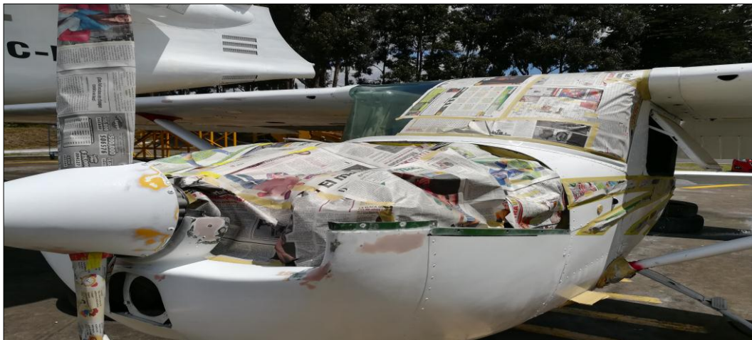
Figura 21 Decapado del compartimiento del motor
