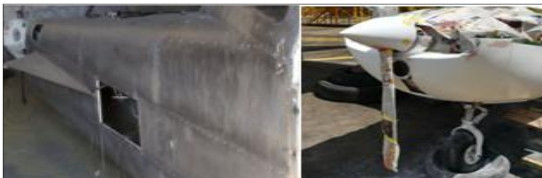
Figura 20 Decapado del fuselaje y trenes de aterrizaje
