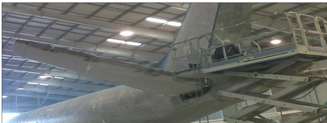
Figura 13 Lijado de Superficie
