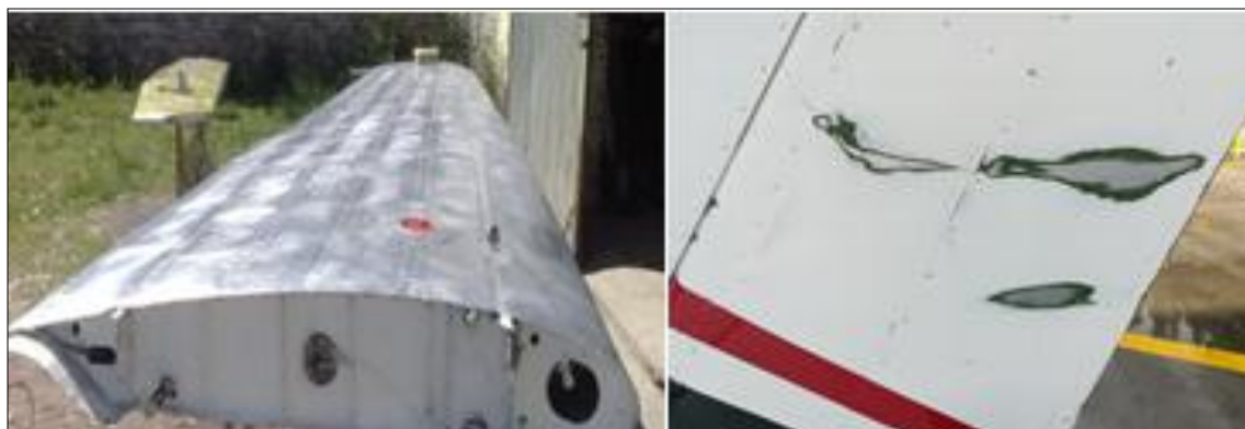
Figura 19 Decapado de alas y estabilizadores
