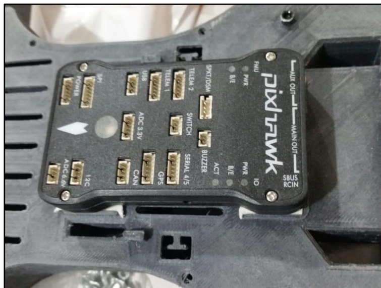
Figura 63. Montaje del Sistema de Control.
