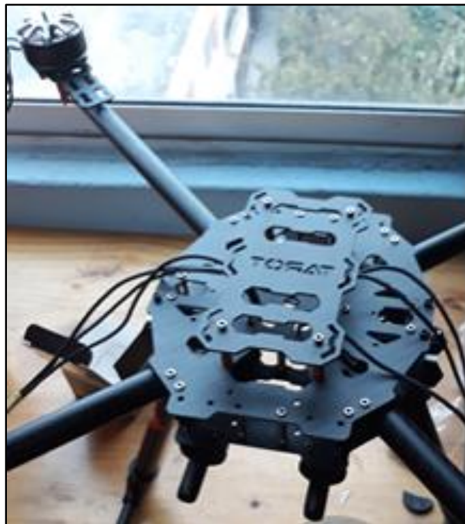
Figura 64. Ensamble de la base y tubos de soporte.
