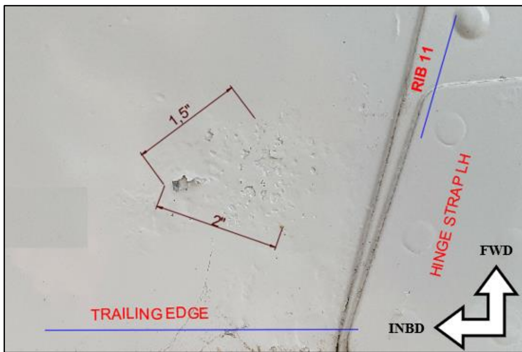
Figura 110. Corrosión en RH horizontal stabilizer.
