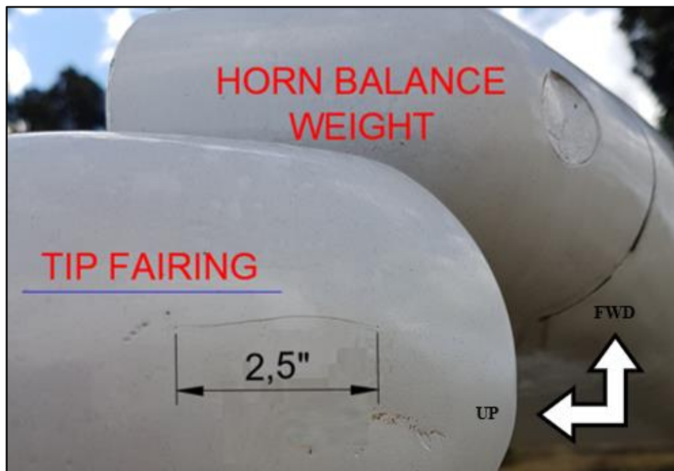
Figura 96. Rajadura en el borde de ataque del estabilizador vertical.
