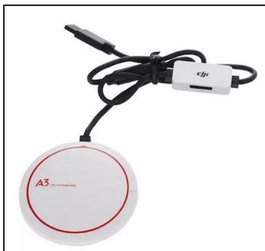
Figura 23. Módulo GPS. Fuente: (DJI, 2017).
