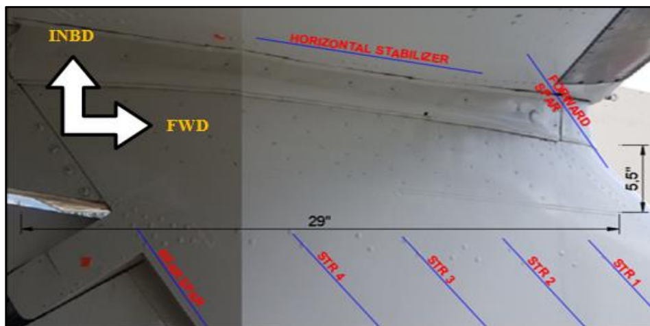
Figura 82. Reparación estructural en el estabilizador vertical.
