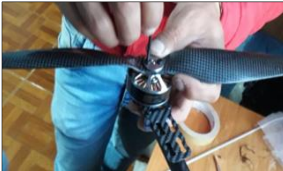
Figura 66. Montaje de las hélices y protecciones en los motores.
