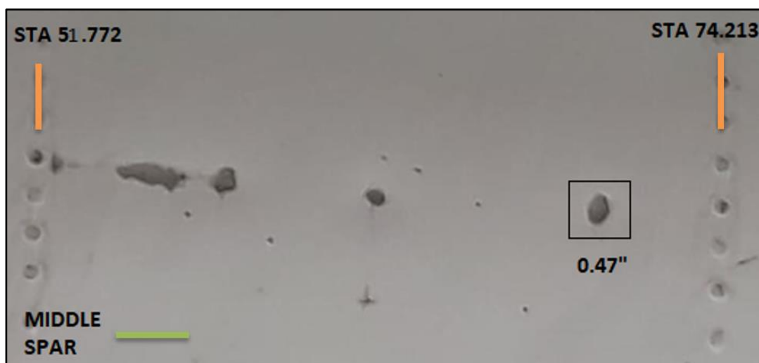
Figura 82. Hundimiento # 7 de la inspección.
