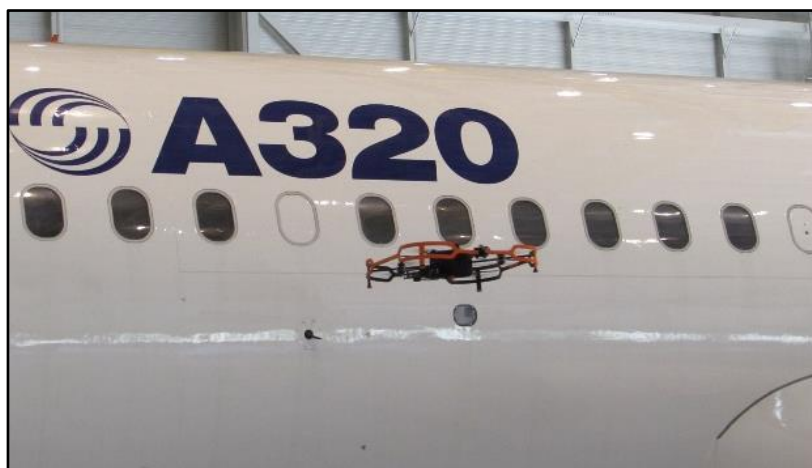
Figura 14. Inspección con drones en el A320. Fuente: (Leonardo, 2018).
