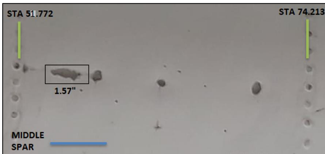
Figura 76. Hundimiento # 4 de la inspección.
