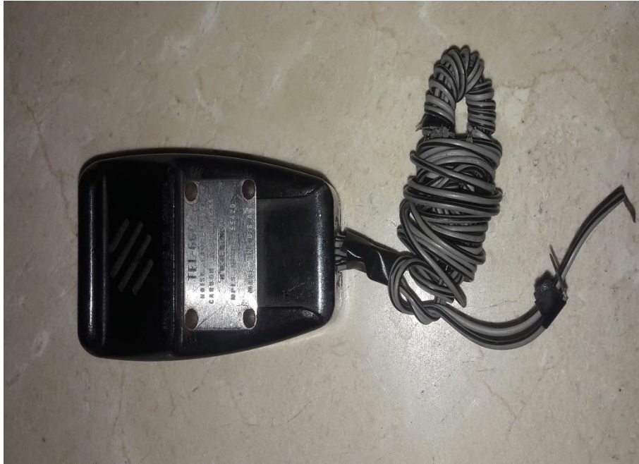
Figura 17. Micrófono con pastilla de Carbón marca Telex
