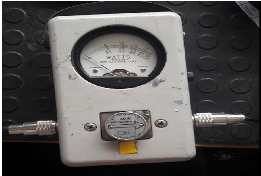
Figura 6. Vatímetro con capsula de 50w en 110 a 250 MHz.
