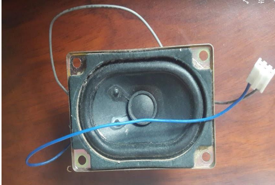
Figura 3: Parlante de 3W 8 Ohmios marca SP Se In
