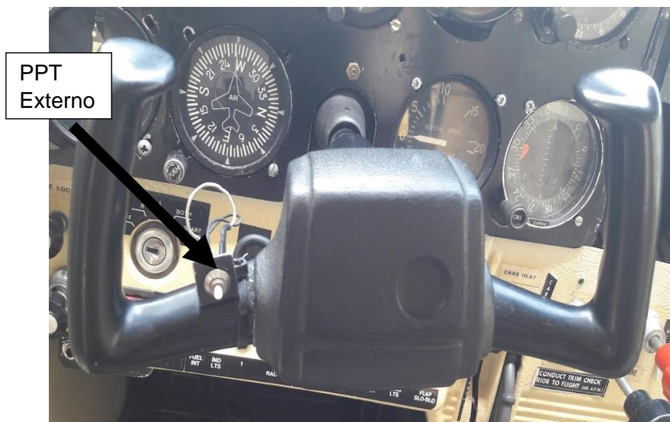
Figura 33. PTT Externo ubicado en la cabrilla
