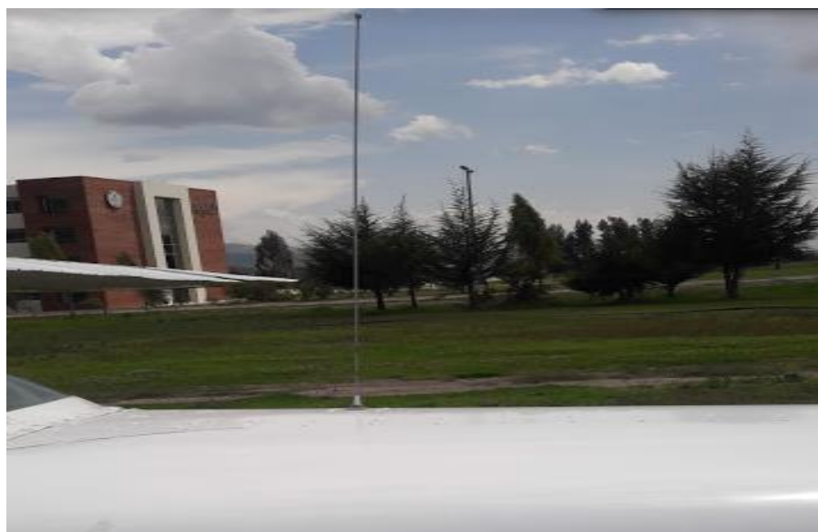
Figura 23. Antena VHF tipo látigo 111.8 a 139.00 MHz
