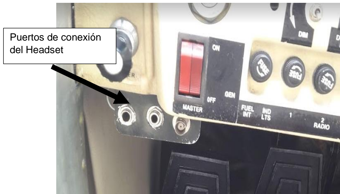
Figura 36. Localización de puertos de conexión Del Headset
