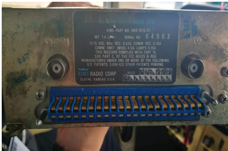
Figura 15. Localización de pines Del equipo Bendix king 170B
