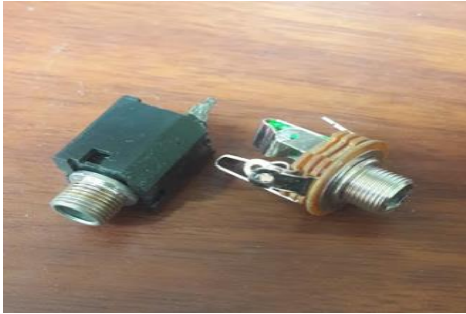
Figura 31. Puerto de entrada Mic., PTT y speaker
