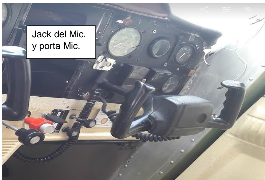
Figura 39. Ubicación de cable de micrófono con porta micrófono
